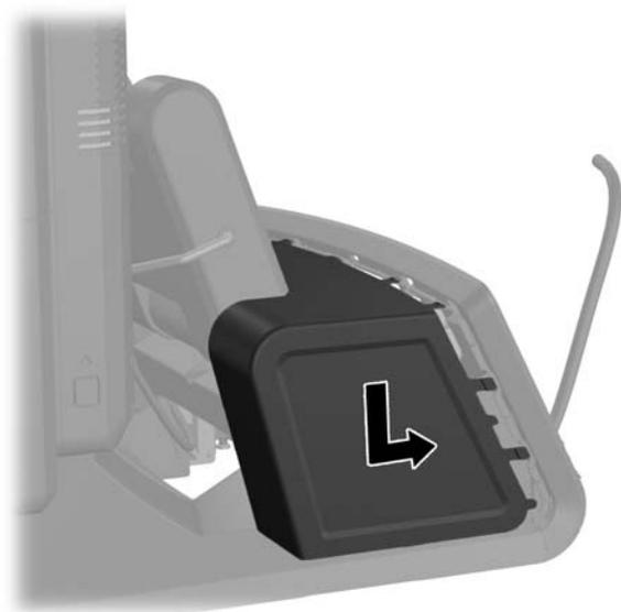
14. 将封盖底部的挂钩置入机箱底部的插槽内，重新将后 I/O 封盖安装好 (1)。然后旋转 I/O 封盖顶部，使其牢固地扣入机箱 (2)。
