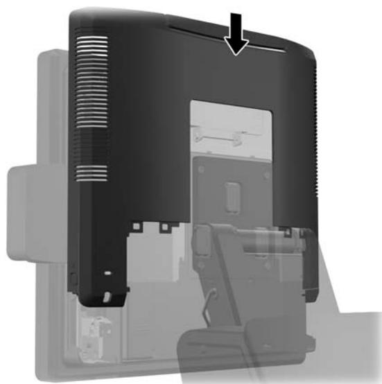
10. 将封盖底部的挂钩置入机箱底部的插槽内，重新将后 I/O 封盖安装好 (1)。然后旋转 I/O 封盖顶部，使其牢固地扣入机箱 (2)。
