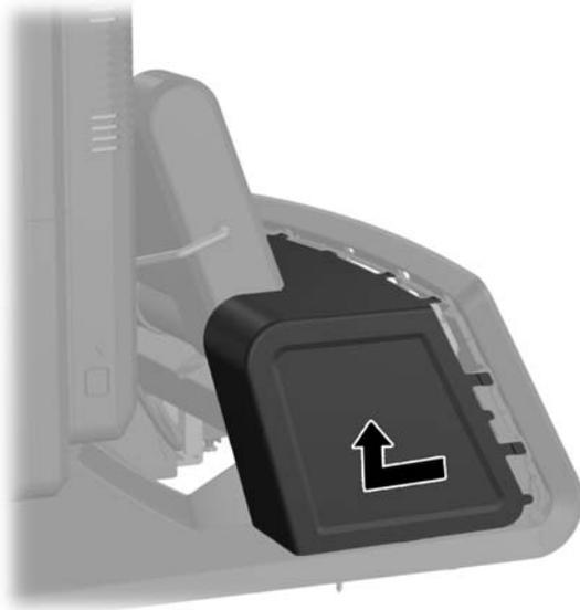
5. 如下所示，轻轻地将面板撬离位于面板顶部和侧面卡舌位置的基座，拆除设备后面的装饰性面板 (1)。然后将面板顶部从基座拉开 (2)，再径直向下推面板，释放底部卡舌 (3)。
