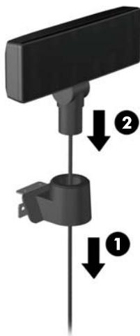
7. Ako VFD postavljate sa spojenim šipkama, povucite jednu ili obje šipke na montažnu prirubnicu, ovisno o željenoj visini VFD zaslona. Provucite VFD kabel kroz gornji dio sklopa šipki i van kroz donji dio montažne prirubnice (1), zatim navucite VFD na sklop šipki (2).
