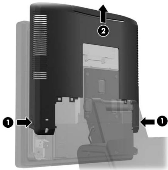
5. Otvorite poklopac tvrdog diska (1), zatim primite jezičac za izvlačenje sa strane tvrdog diska i izvucite tvrdi disk iz pretinca (2).
