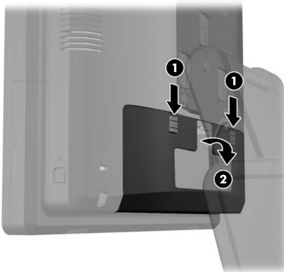
4. Pritisnite prema unutra na gumbima blizu dna stranica stražnje ploče monitora (1) i zatim povucite stražnju ploču prema gore i skinite ju s monitora (2).
