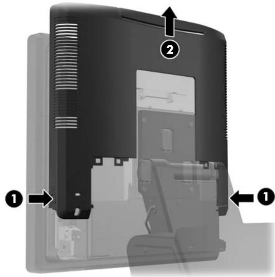
5. Uklonite dva vijka koji drže pokrovnu ploču za USB za monitor (1) i zatim povucite pokrovnu ploču s monitora (2). Uklonite samo pokrovnu ploču koja je na mjestu gdje želite ugraditi USB modul.
