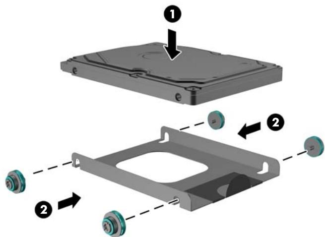
8. Umetnите sklop tvrdog diska i nosača u pretinac za disk (1) i zatvorite poklopac za disk (2).
