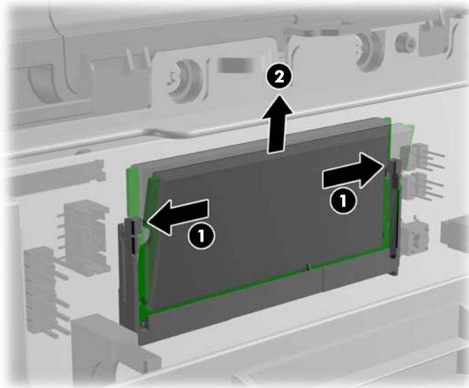
7. Da biste ugradili SODIMM, umetnите novi SODIMM u utor pod kutom od približno  $30^{\circ}$  (1), a zatim pritisnite SODIMM prema dolje u utor (2) tako da ga kopče učvrste u ležištu.
