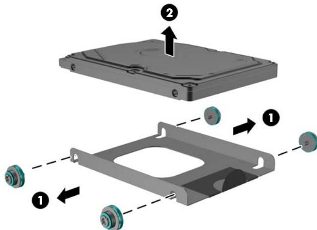
7. Postavite novi tvrdi disk u nosač (1) i ugradite četiri vijka u strane nosača (2).
