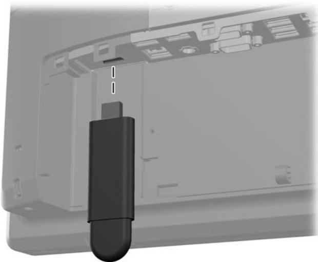
6. Umetnute vrh USB sigurnosnog poklopca u ulazno-izlaznu ploču pod kutom s lagano podignutim dnom poklopca (1), zatim rotirajte dno prema dolje tako da poklopac uskoči na mjesto (2).
