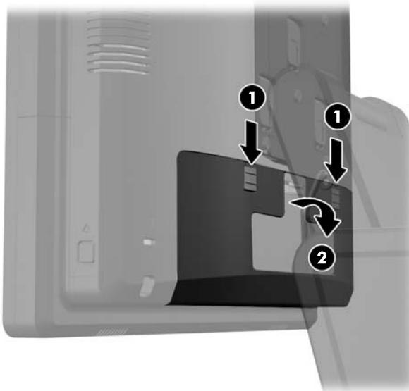
4. Povucite poklopac napajanja nazad i zatim ga podignite s uređaja.
