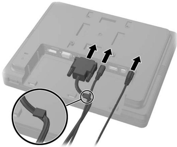
7. Provucite audio, DVI i kabele napajanja kroz rupu u stražnjoj ploči zaslona za klijente (1). Spojite stražnju ploču na zaslon za klijente tako da poravnate kuke na stražnjoj ploči s utorima na stražnjoj strani zaslona i povučete stražnju ploču prema gore (2) tako da se rupe za vijke na stražnjoj ploči poravnaju s rupama za vijke na zaslonu. Ugradite dva vijka za učvršćivanje stražnje ploče na zaslon (3).
