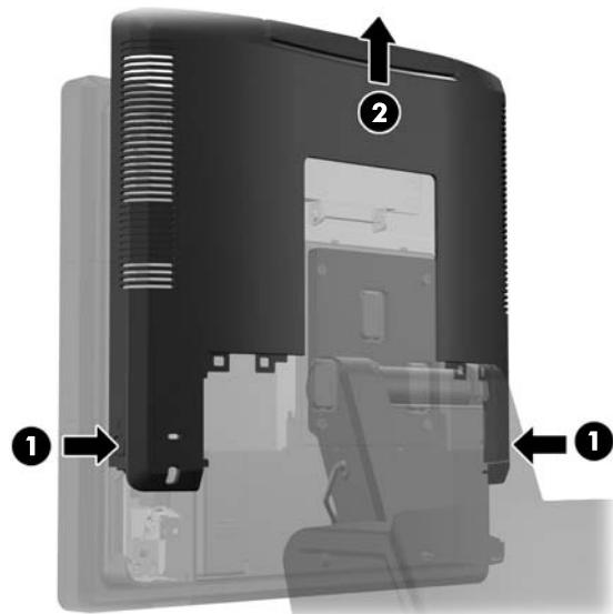
7. Skinite monitor RP7 sa stalka tako da izvadite tri vijka koji drže nosač stalka za monitor (1) i zatim povucite monitor prema gore i skinite ga s nosača (2).
