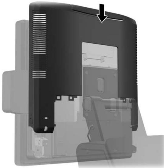
10. Vratite stražnji ulazno-izlazni poklopac postavljanjem kuka na dnu poklopca u utore na dnu okvira (1). Zatim zakrenite vrh ulazno-izlaznog poklopca tako da sigurno uskoči na okvir (2).
