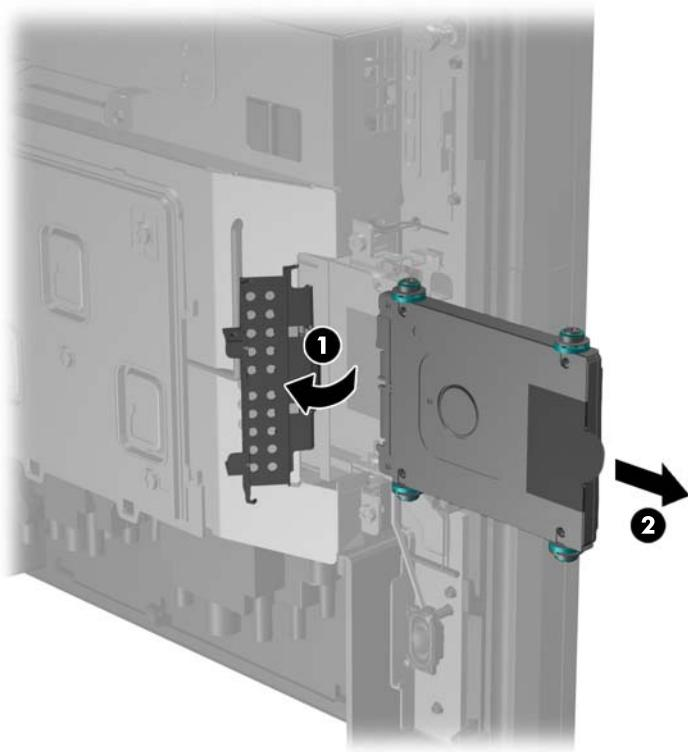
6. Uklonite četiri vijka s obje strane nosača tvrdog diska (1) i podignite tvrdi disk iz nosača (2).
