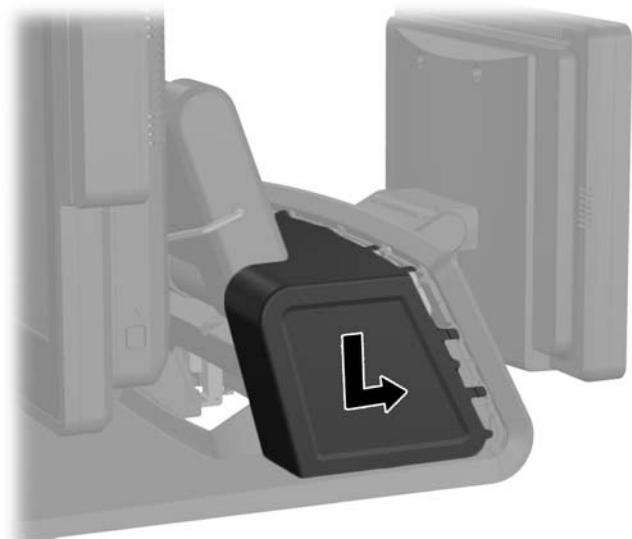
13. Vratite stražnji ulazno-izlazni poklopac postavljanjem kuka na dnu poklopca u utore na dnu okvira (1). Zatim zakrenite vrh ulazno-izlaznog poklopca tako da sigurno uskoči na okvir (2).
