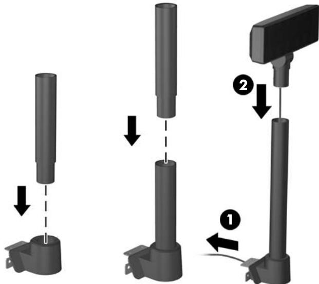
8. Provucite VFD kabel kroz rupu u ukrasnoj ploči isporučenoj s VFD zaslonom, zatim kroz stražnju stranu baze (1) i van kroz prednju stranu baze. Nastavite s provlačenjem produžnog kabela kroz držać kabela (2) i spojite VFD kabel na 12 V USB priključak na RP7 (3).
