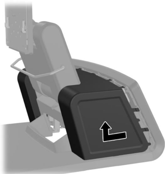
5. Uklonite dekorativnu ploču na stražnjoj strani uređaja nježnim odvajanjem ploče od dna na mjestima gdje su jezičci na vrhu i stranama ploče, kako je prikazano dolje (1). Zatim povucite vrh ploče od dna (2) i pogurajte ploču prema dolje radi otpuštanja donjih jezičaca (3).
