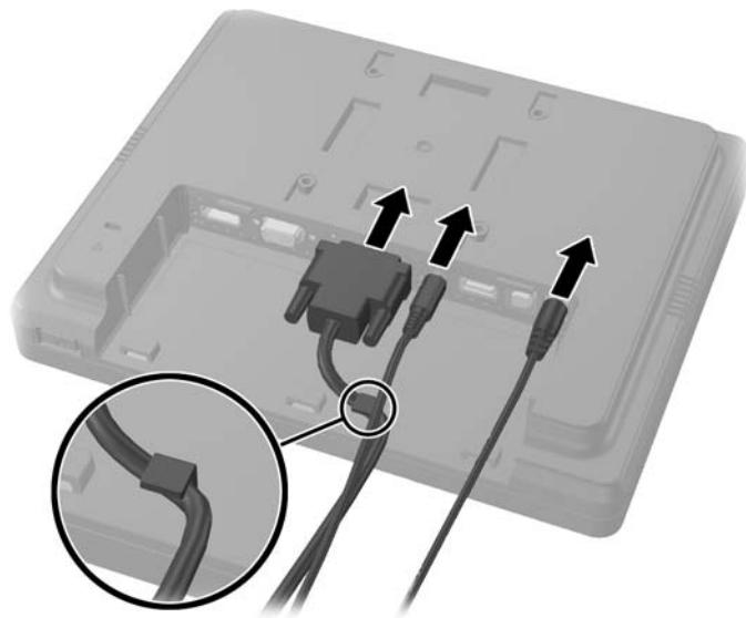
7. Provucite kablove za audio, DVI i napajanje kroz otvor na zadnjoj ploči ekrana za mušterije (1). Povežite zadnju ploču sa ekranom za mušterije tako što ćete poravnati kvačice na zadnjoj ploči sa otvorima na pozadini ekrana i klizeći potisnuti zadnju ploču nagore (2) tako da se otvori za zavrtanje na zadnjoj ploči poravnaju sa otvorima za zavrtanje na ekranu. Namontirajte dva zavrnja kako biste pričvrstili zadnju ploču za ekran (3).
