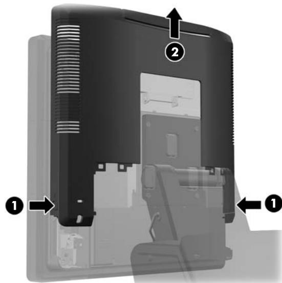
7. Skinite glavu ekrana RP7 sa postolja tako što ćete ukloniti tri zavrtnja koji pričvršćuju držač za montiranje postolja za glavu ekrana (1), a zatim ekran klizeći potisnite nagore i skinite ga sa držača za montiranje (2).
