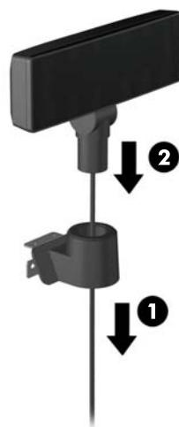
7. Ako instalirate VFD sa pripojenim stubićima, klizeći namestite ili jedan ili dva stubića na držač za montiranje, u zavisnosti od željene visine VFD. Provucite VFD kabl kroz vrh sklopa stubića i kroz dno držača za montiranje (1), zatim klizeći namestite VFD na sklop stubića (2).
