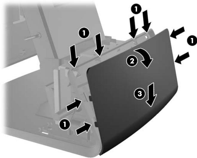
6. Ako instalirate VFD bez pripojenih stubića, umetnите VFD kabl kroz centar držača za montiranje (1) i klizeći namestite VFD na držač za montiranje (2).
