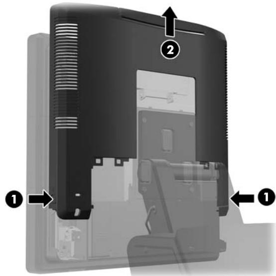
5. Pritisnite polugu na vratancima za pristup memoriji (1) i okrenite i otvorite vratanca (2).
