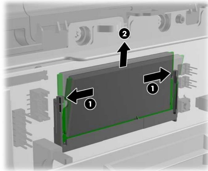
7. Da biste ugradili SODIMM, klizeći ubacite novi SODIMM u ležište pod uglom od približno  $30^\circ$  (1), a zatim pritisnite SODIMM ka ležištu nadole (2) kako bi se reze zaključale u mestu.
