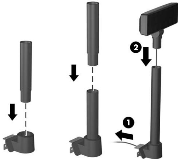
8. Provucite produžni VFD kabl priložen uz VFD kroz otvor u dekorativnoj ploči, a zatim kroz poleđinu osnove (1) tako da izađe na prednji deo osnove. Dalje provlačite produžni kabl nagore kroz držač kabla (2) i povežite VFD kabl na 12V USB port na RP7 (3).
