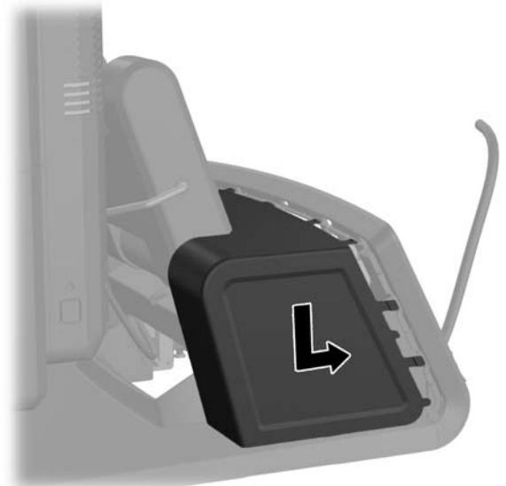
14. Vratite poklopac zadnje ploče sa U/I tako što ćete ubaciti kvačice na donjem delu poklopca u otvore na dnu kućišta (1). Zatim, zarotirajte gornji deo poklopca ploče sa U/I tako da škljocne kada nalegne i prikači se za kućište (2).
