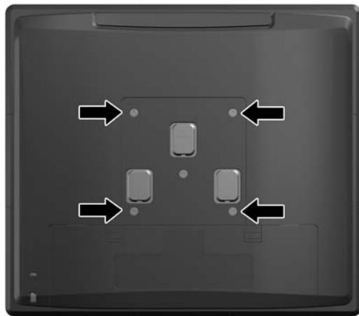
Za ovaj aparat je predviđeno da ga drži zidni nosač sa oznakama UL (Garantne laboratorije) ili CSA (Kanadsko udruženje za standarde). HP preporučuje da koristite HP Quick Release držač za zidno montiranje (broj dela EM870AA).
