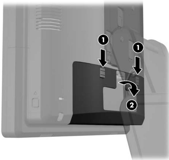
4. Povucite poklopac za napajanje ka nazad, a zatim ga podignite i uklonite sa jedinice.
