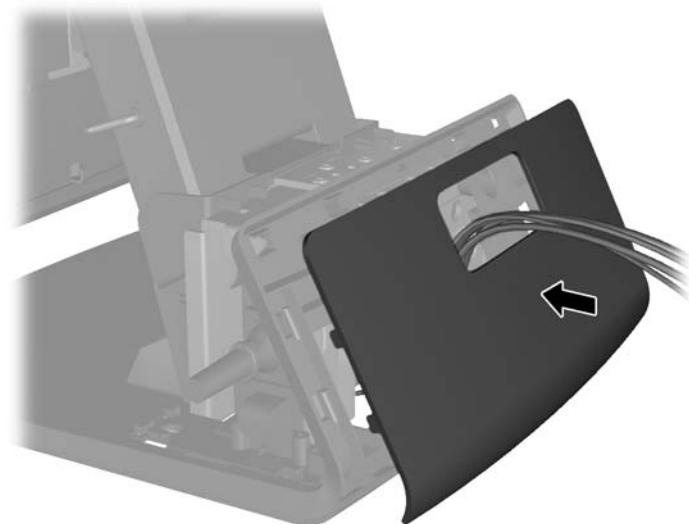
11. Klizeći ubacite zadnju ploču držača za montiranje u otvor za montiranje na poleđini osnove RP7 (1) i namontirajte dva zavrtnja priložena uz ekran za mušterije u otvore za zavrtnje na držaču za montiranje (2).
