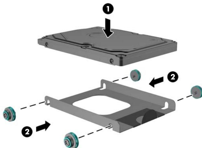
8. Klizeći ubacite sklop čvrstog diska i nosača u odeljak za disk jedinicu (1) i zatvorite vratanca čvrstog diska (2).
