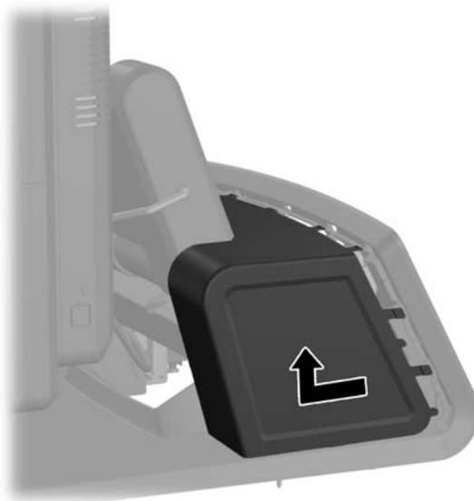
5. Quite el panel decorativo en la parte trasera de la unidad haciendo palanca para sacarlo de la base en las ubicaciones de las pestañas en la parte superior y los laterales del panel como se muestra abajo (1). Luego jale la parte superior del panel de la base (2) y presione hacia abajo el panel para liberar las pestañas inferiores (3).
