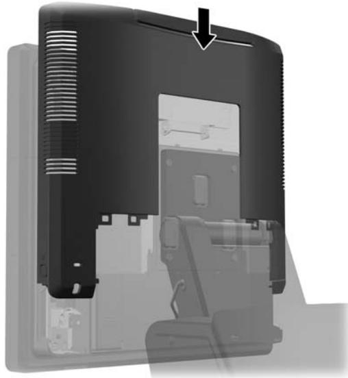
10. Vuelva a colocar la cubierta de E/S trasera colocando los ganchos en la parte inferior de la cubierta en las ranuras en la parte inferior del chasis (1). Luego, rote la parte superior de la cubierta de E/S hacia arriba para que encaje de manera segura sobre el chasis (2).
