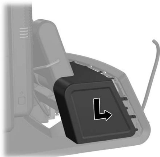
14. Vuelva a colocar la cubierta de E/S trasera colocando los ganchos en la parte inferior de la cubierta en las ranuras en la parte inferior del chasis (1). Luego, rote la parte superior de la cubierta de E/S hacia arriba para que encaje de manera segura sobre el chasis (2).
