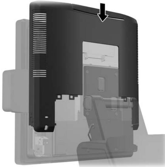
10. Vuelva a colocar la cubierta de E/S trasera colocando los ganchos en la parte inferior de la cubierta en las ranuras en la parte inferior del chasis (1). Luego, rote la parte superior de la cubierta de E/S hacia arriba para que encaje de manera segura sobre el chasis (2).
