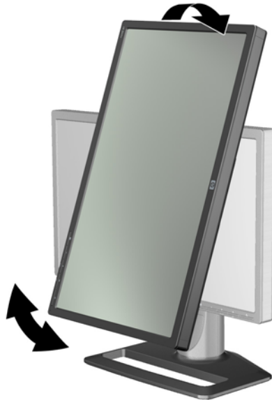
Figure 2-23 Pivotement du moniteur (certains modèles uniquement)
