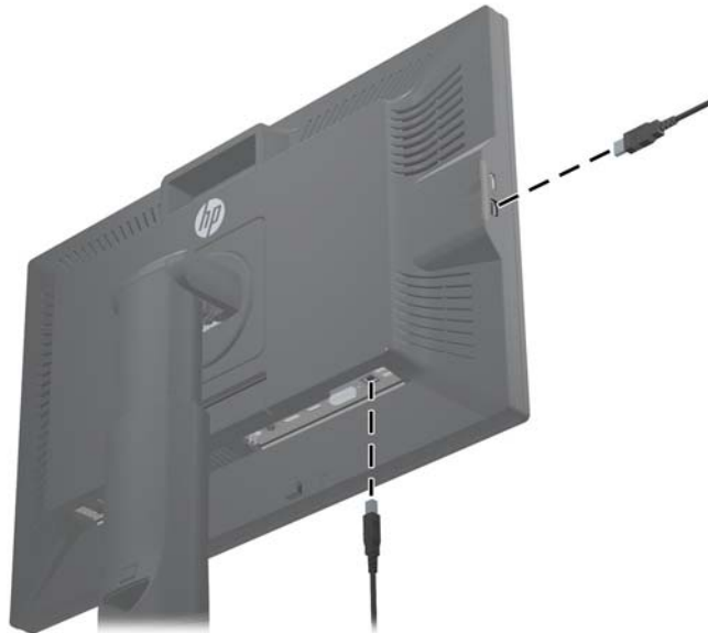
Figure 2-11 Connexion des câbles USB
