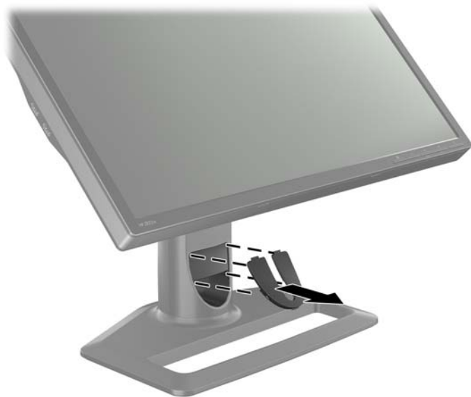
图 2-9 电缆布线盖板
