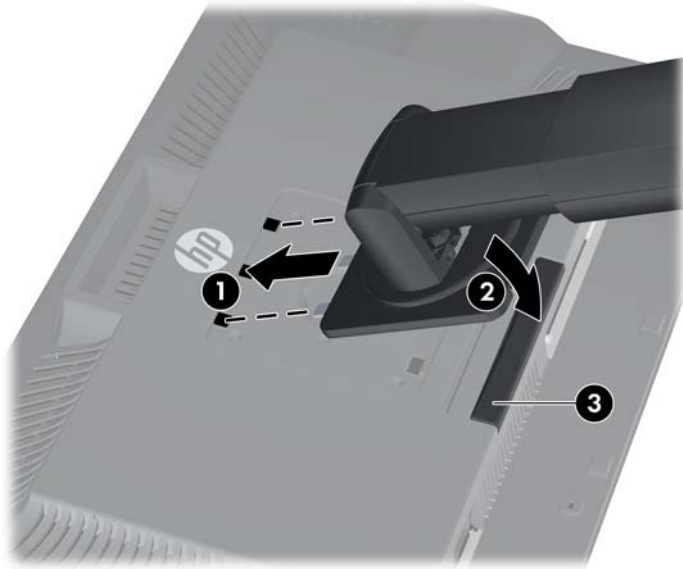
图 2-2 将面板安装在 HP 液晶显示器悬挂解决方案 2 上
