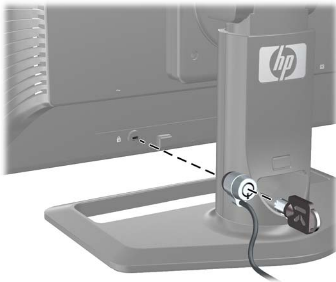
Gambar 2-19 Memasang Kunci Kabel
