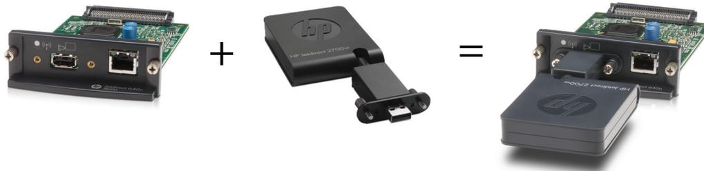
Puede adquirir el Servidor de impresión HP Jetdirect 695n como un paquete y luego conectarlos. O bien, puede adquirir el Servidor de impresión HP Jetdirect 640n y el Servidor de impresión solución USB HP Jetdirect 2700w por separado y conectarlos. Para obtener instrucciones de instalación, consulte [Cree el Servidor de impresión HP Jetdirect 695n \(conecte el HP Jetdirect 2700w\) en la página 13](#). (Hágalo después de haber instalado correctamente el Servidor de impresión HP Jetdirect 640n).
