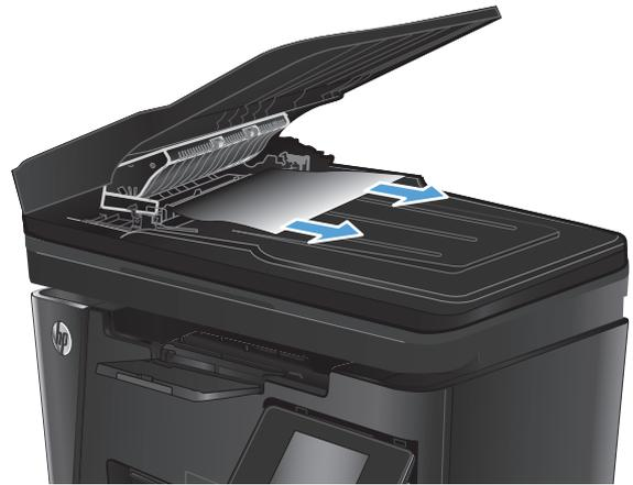
6. Schließen Sie die Zugangsklappe für Papierstaus.
