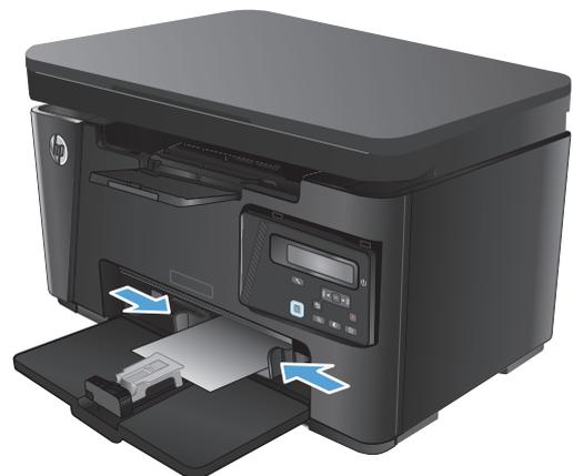
4. Legen Sie das Papier bis zum Anschlag in das Gerät, und schieben Sie dann die Papierlängsführung so, dass die Verlängerung das Papier hält.
