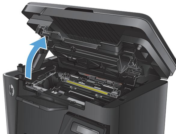
3. 取出出纸槽区域的任何卡纸。使用双手取出卡纸，以免撕破纸张。
