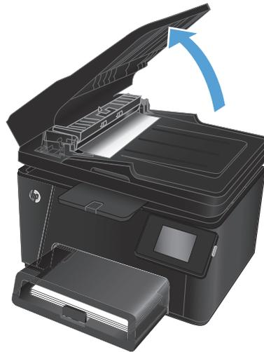
3. Heben Sie die Zugangsklappe für Papierstaus an.
