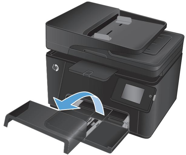
2. Legen Sie das Papier in das Fach ein. Stellen Sie sicher, dass sich das Papier vollständig unterhalb der Halterungen und unterhalb der Markierungen für die maximale Stapelhöhe befindet.
