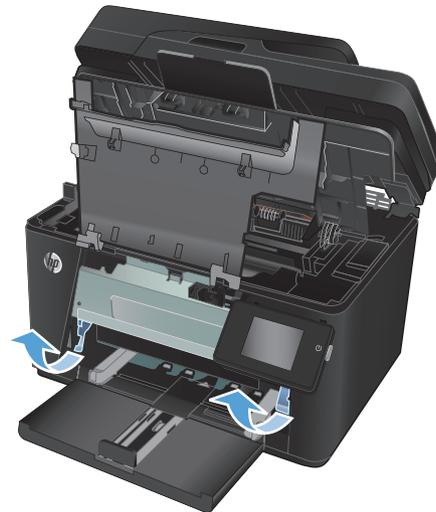
6. Entfernen Sie die alte Bildtrommel.
