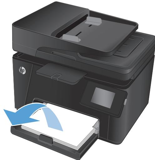
3. Entfernen Sie das gestaute Papier aus dem Zufuhrfach. Entfernen Sie gestautes Papier mit beiden Händen, um zu verhindern, dass das Papier reißt.
