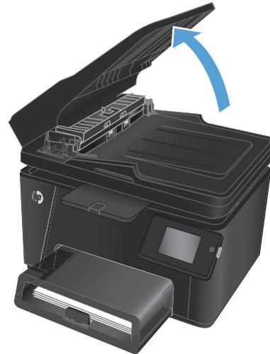
2. Wischen Sie sowohl die Einzugsrollen als auch die Trennvorrichtung mit einem feuchten, fusselreien Tuch ab, um Schmutzablagerungen zu entfernen.
