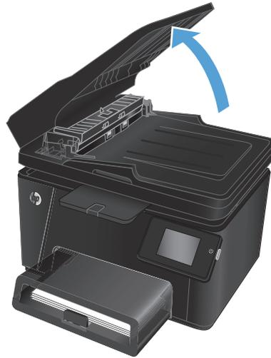
2. Wischen Sie sowohl die Einzugsrollen als auch die Trennvorrichtung mit einem feuchten, fusselfreien Tuch ab, um Schmutzablagerungen zu entfernen.
