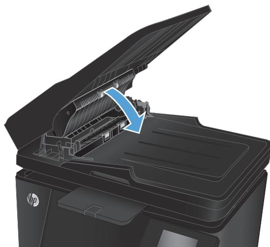
6. Schließen Sie das Zufuhrfach des Vorlageneinzugs.
