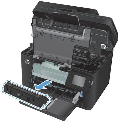
7. Entnehmen Sie die neue Bildtrommel aus der Verpackung. Legen Sie die gebrauchte Bildtrommel zum Recycling in die Verpackung.
