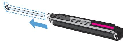
9. Richten Sie die Tonerpatrone an den Führungswalzen im Gerät aus. Schieben Sie die Tonerpatrone so weit hinein, bis sie fest einrastet.
