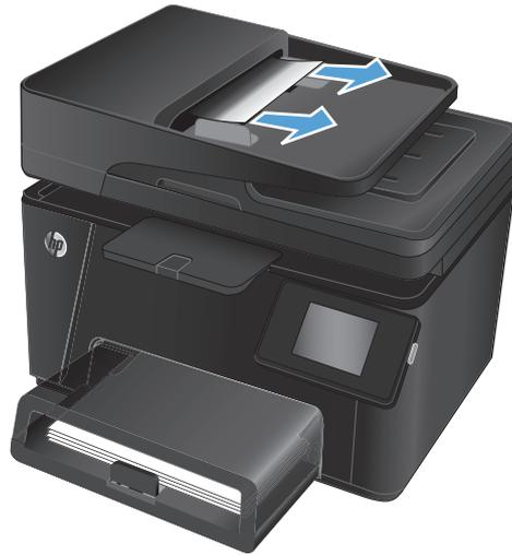
2. Heben Sie das Zufuhrfach des Vorlageneinzugs an.
