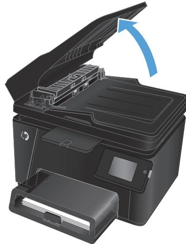
2. Utilizzare un panno liscio e umido per pulire i rulli di prelievo e il tampone di separazione.
