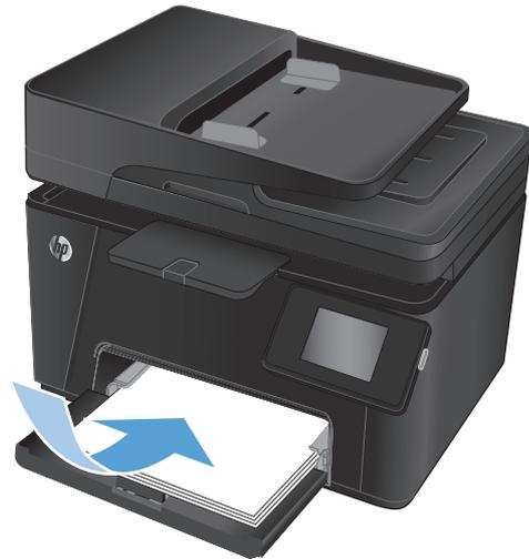
5. Vuelva a instalar la cubierta protectora de la bandeja.
