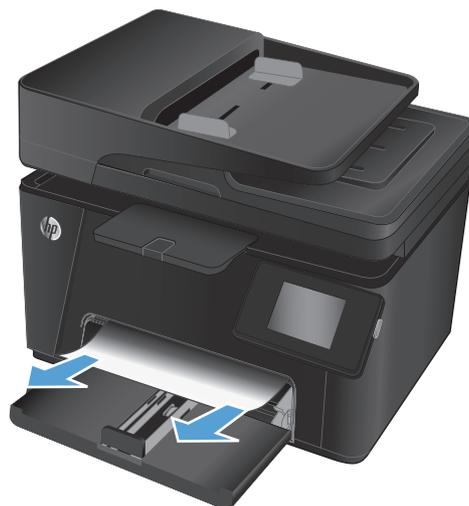
4. Vuelva a cargar papel en la bandeja de entrada. Asegúrese de que el papel se ajusta por debajo de las pestañas y por debajo de los indicadores de altura máxima.
