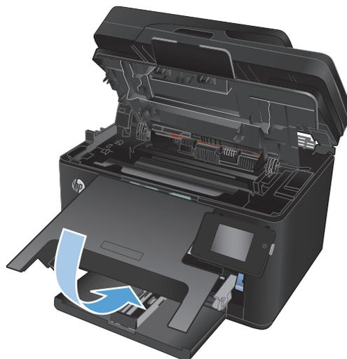
**12.** Vuelva a instalar la cubierta protectora de la bandeja.
