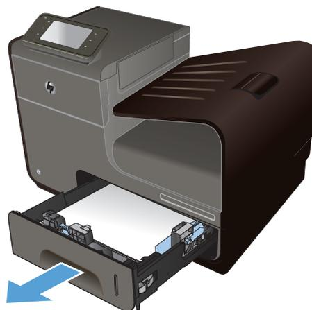
2. Entnehmen Sie das eingeklemmte Blatt, indem Sie es nach rechts und dann aus dem Produkt ziehen.
