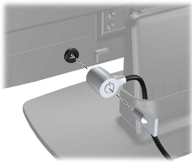
Figur 2-10 Installere en kabellås
