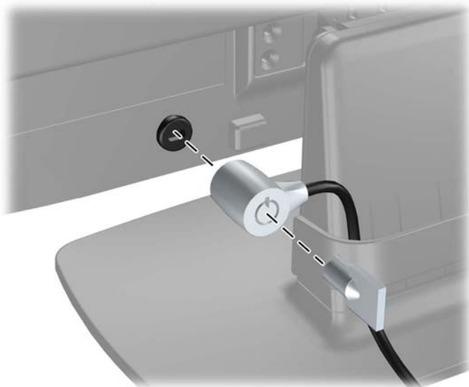
Figura 2-10 Instalación de un bloqueo de cable
