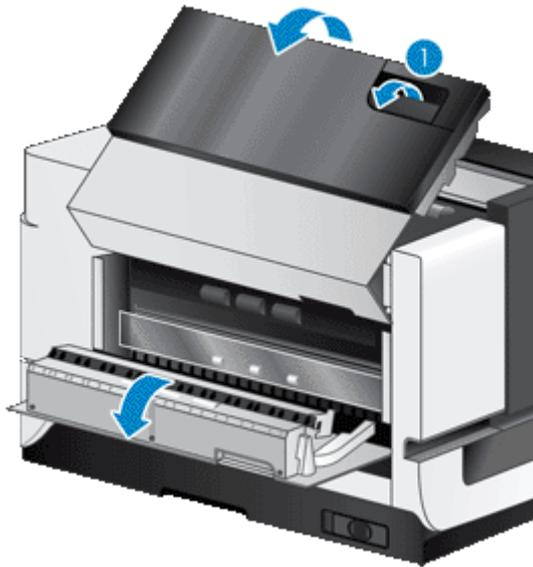
6. Repérez la bande blanche située sur la porte d'accès latérale du bac d'alimentation automatique et nettoyez la fenêtre de numérisation dans la partie intérieure de celui-ci. Nettoyez ces deux zones à l'aide d'un chiffon propre, légèrement humidifié et non pelucheux.
