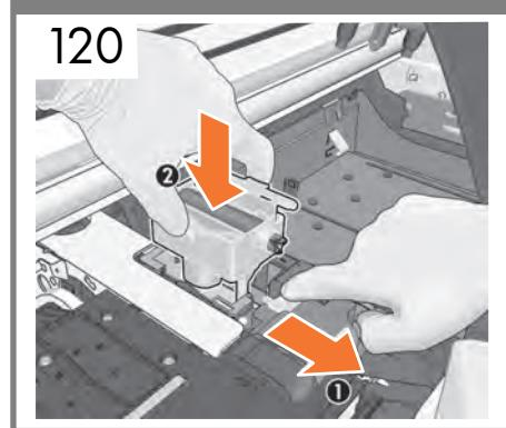
**FR** Introduisez le tube d'assemblage à fond, puis insérez la pièce à l'extrémité dans le trou comme indiqué.
