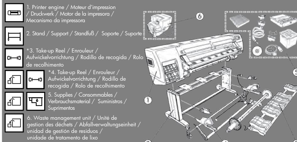
\* For the HP Designjet L26100 Printer, the take-up reel is available only as an accessory / Pour le modèle HP Designjet L26100 Printer, la bobine réceptrice n'est disponible qu'en tant qu'accessoire / Für den HP Designjet L26100 Printer ist die Aufwickelvorrichtung nur als Zubehör erhältlich / Para la HP Designjet L26100 Printer, el rodillo de recogida solamente está disponible como un accesorio / O rolo de recolhimento está disponível apenas como acessório para a impressora HP Designjet L26100
