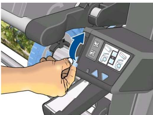
9. Remova o rolo da impressora, puxando a extremidade no lado direito da impressora primeiro. Não coloque os dedos nos suportes do eixo durante o processo de remoção.
