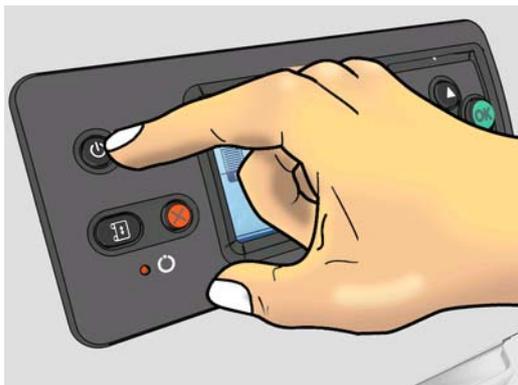
Quando você desliga a impressora dessa forma, os cabeçotes de impressão são automaticamente armazenados com os cartuchos dos dispositivos de limpeza, o que previne que eles sequem.
