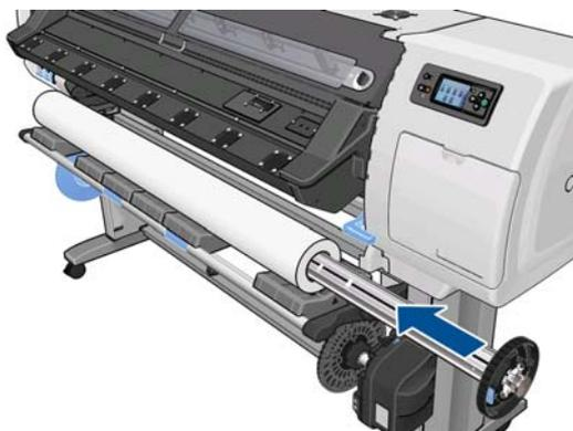
8. A parada direita do eixo tem duas posições: uma para rolos da largura máxima da impressora e outro para rolos mais estreitos. Lembre-se de usar a segunda posição para rolos mais estreitos, otimizando o processo de secagem e permitindo velocidades de impressão mais altas.
