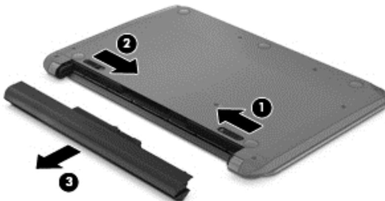
**📝 ПРИМЕЧАНИЕ.** Фиксатор батареи автоматически вернется в исходное положение. Фиксатор батареи остается в разблокированном положении.
