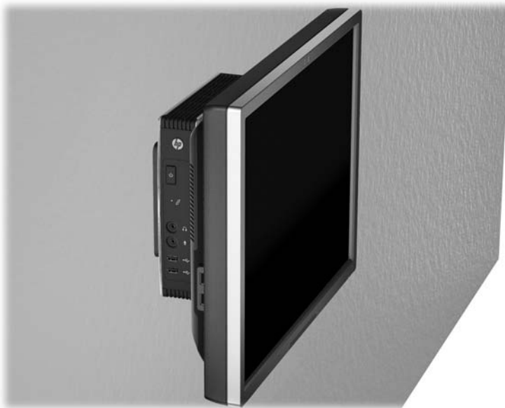
图 C-5 瘦客户机与平板监视器一起安装在墙上
