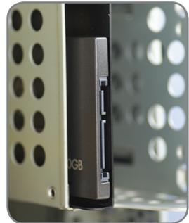
**安裝完成** - 請確保所有系統部件已牢固地鎖緊，並參閱系統製造商所提供的使用手冊以獲得系統通電說明。在使用前，根據作業系統和系統要求，應對惠普固態硬碟進行格式化。
