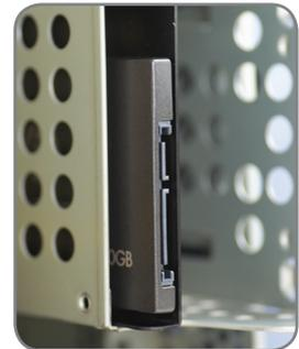
**取り付け完了** - すべてのシステムコンポーネントがしっかり固定されていることを確認します。システムを起動するには、システムの製造元発行の取扱説明書を参照してください。ご使用前に HP SSD はお使いのOS とシステム要件に基づいてフォーマットする必要があります。
