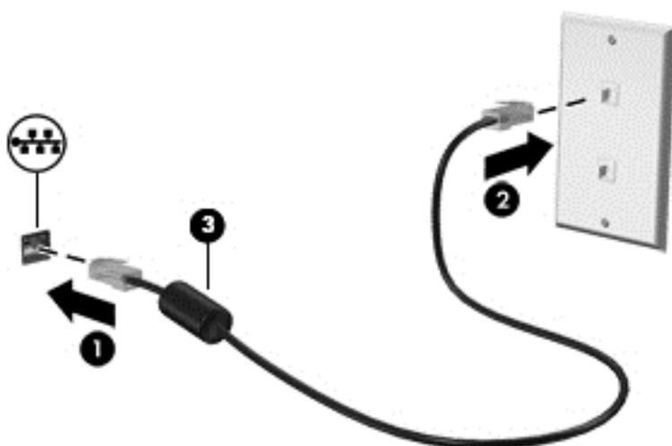
**⚠ AVERTISSEMENT !** Pour éviter les risques de décharge électrique, d'incendie ou de détérioration du matériel, ne branchez pas de câble modem ou téléphonique sur la prise RJ-45 (réseau).
