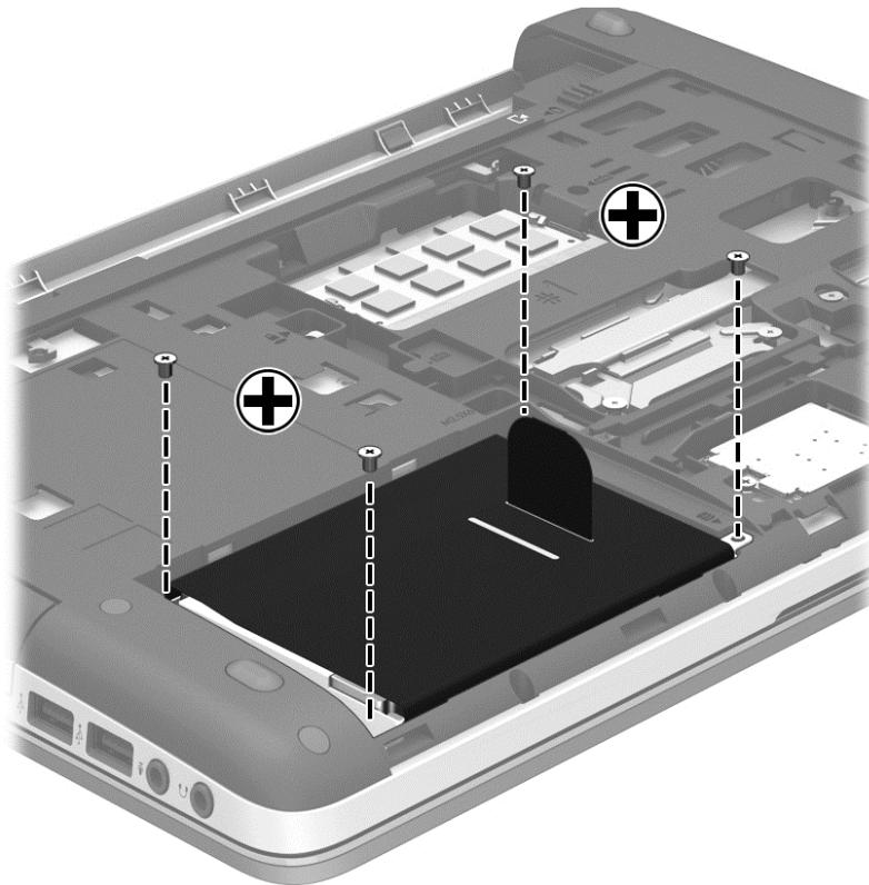
9. 將硬碟定位片 (1) 往電腦側邊拉動，以抽離硬碟。
