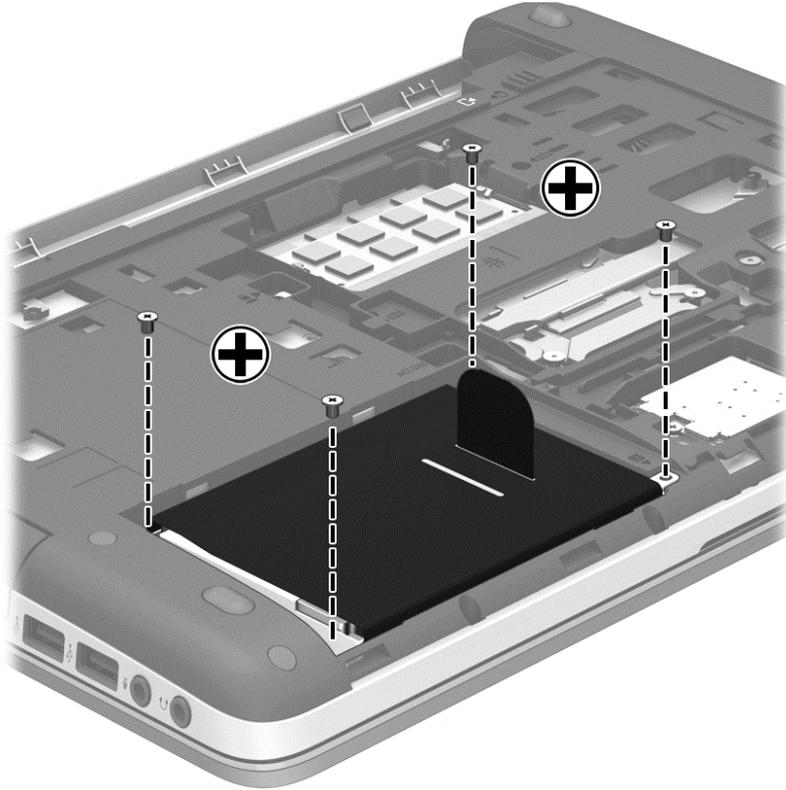
9. Tire de la pestaña de la unidad de disco duro **(1)** hacia el lado del equipo para desconectar la unidad.
