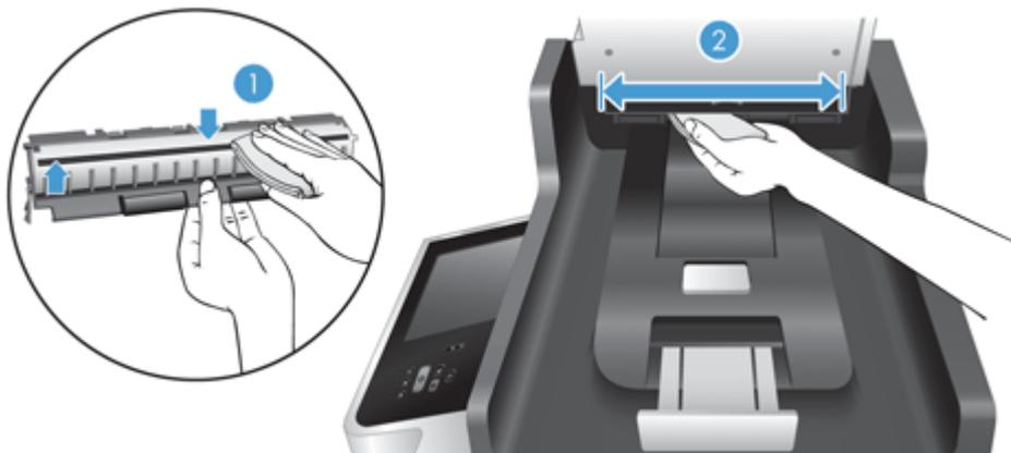
8. Seque as faixas de digitalização com um pano macio, seco e sem fiapos e deslize o componente para dentro de seu alojamento até que as duas linguetas se encaixem no lugar.
