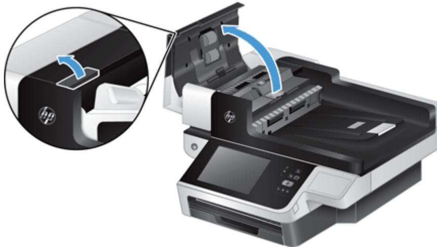
3. Remova qualquer fiapo ou sujeira visível dos roletes de alimentação e da almofada de separação usando ar comprimido ou um pano limpo sem fiapos umedecido com água morna.
