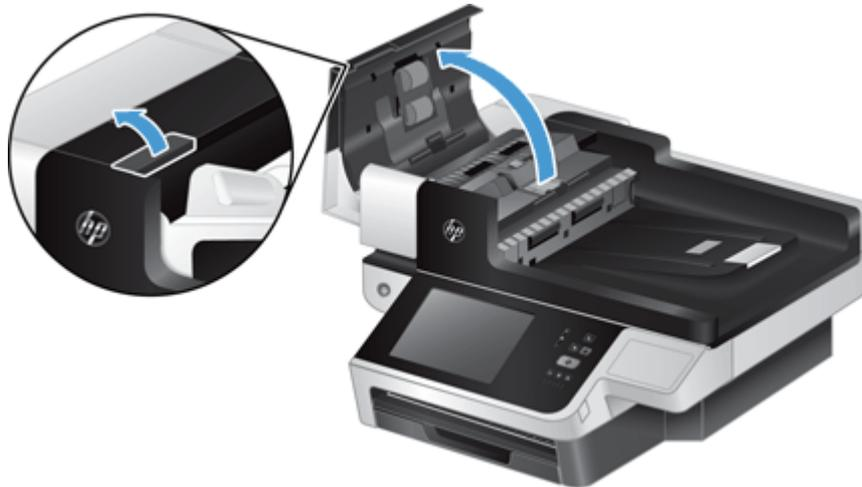
3. Levante a bandeja de entrada do ADF (1) e pressione a trava da almofada de separação para a frente para liberar a almofada da posição de travamento (2).
