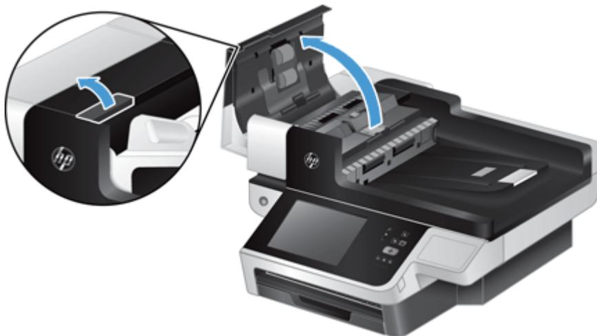
3. 将指尖滑动滚筒装配门上的卡舌后面，然后轻轻地向前并向下拉将门打开。
