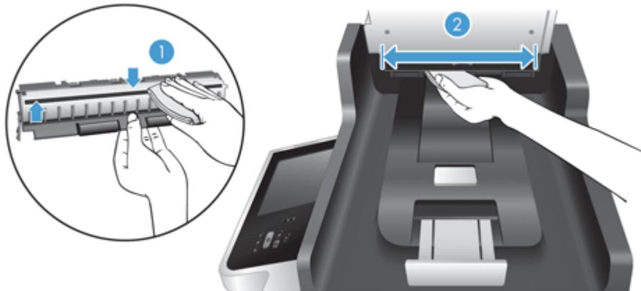
8. 用干燥、无绒毛的软布将扫描带擦干，然后将此组件滑入其机架中，直至两个卡舌锁定入位。
