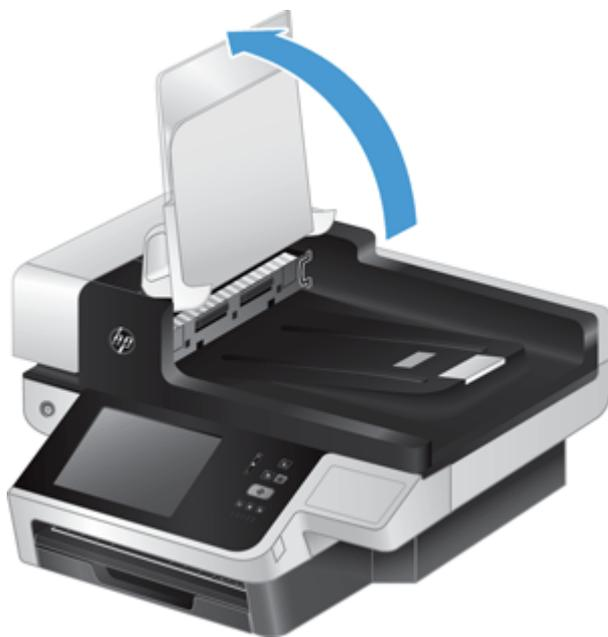
6. 向内按 ADF（自动文档送纸器）双面外壳上的两个卡舌以松开 ADF（自动文档送纸器）双面外壳 (1)，然后向前拉 ADF（自动文档送纸器）双面外壳以从其外罩 (2) 中将其取出。
