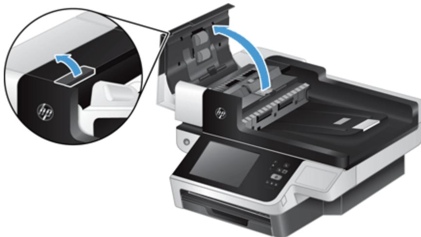
3. 抬起 ADF (自动文档送纸器) 进纸盘 (1), 然后向前按下分隔垫弹簧锁以将分隔垫从其锁定位置 (2) 松开。
