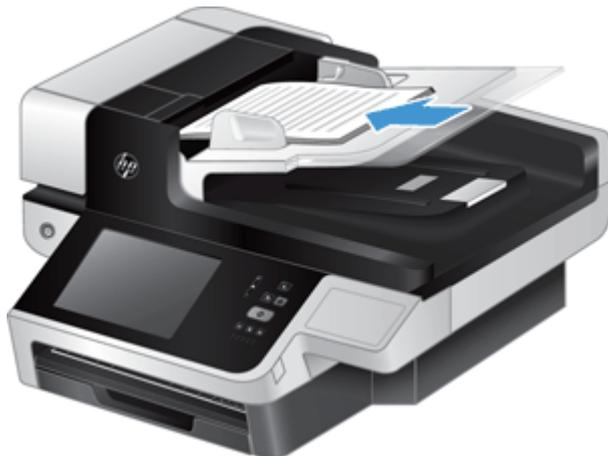
**提示：** 请避免放入前缘已折叠或磨损的文档。开始扫描时，请选择其纸张放入选择同您先放入边缘相匹配的配置文件，以确保扫描件能反映原文档的方向。
