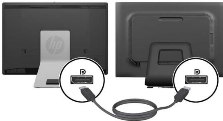
4. Falls Ihr zweites Display keinen DisplayPort-Anschluss hat, verbinden Sie den DisplayPort Video-Adapter mit dem DisplayPort-Anschluss des Computers. Dann schließen Sie ein Kabel (VGA, DVI oder HDMI, je nach Ihrer Anwendung) zwischen dem Adapter und einem zweiten Display.
