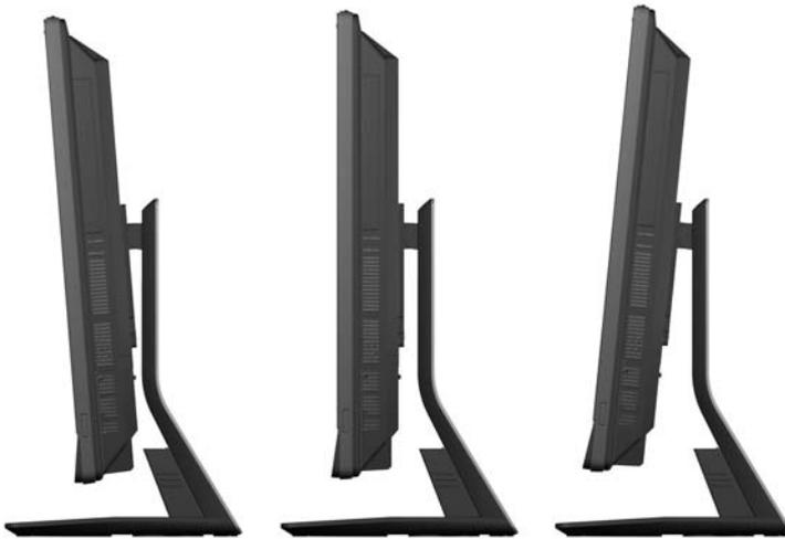
Der dreh- und neigbare Ständer hat ein Drehsystem an der Unterseite, das es Ihnen ermöglicht, den Computer für den besten Ansichtswinkel bis zu 360 Grad nach links oder rechts zu drehen.
