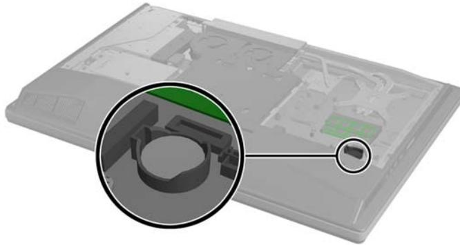
7. Um die Batterie aus der Halterung zu lösen, drücken Sie auf die an einer Seite über die Batterie hinausstehende Metallklammer. Die Batterie springt aus der Halterung, und Sie können sie herausnehmen (1).
