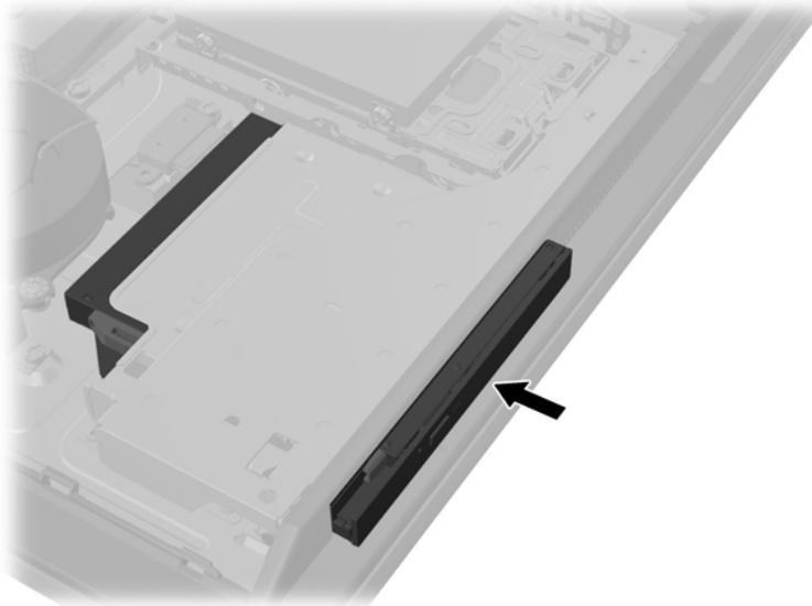
11. Um die Zugangsabdeckung zurückzulegen, bringen Sie die Abdeckung an die Rückseite des Computers etwas über den Ständer an und schieben Sie sie nach unten in ihre Position.
