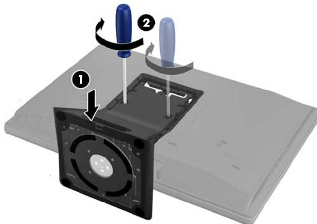
5. Bringen Sie die Spitze der Rückseite des Stands in eine Linie mit dem Stand und drücken Sie sie in ihre Position, indem Sie entlang der Seiten schieben, bis sie einrastet.
