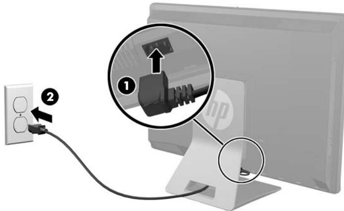
5. Verbinden Sie den 3-Punkt-Netzstecker mit einer Steckdose (2).
