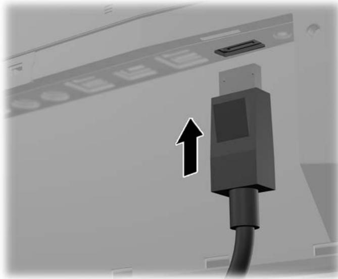
**Abbildung 2-23** Anschließen eines zweiten Displays
