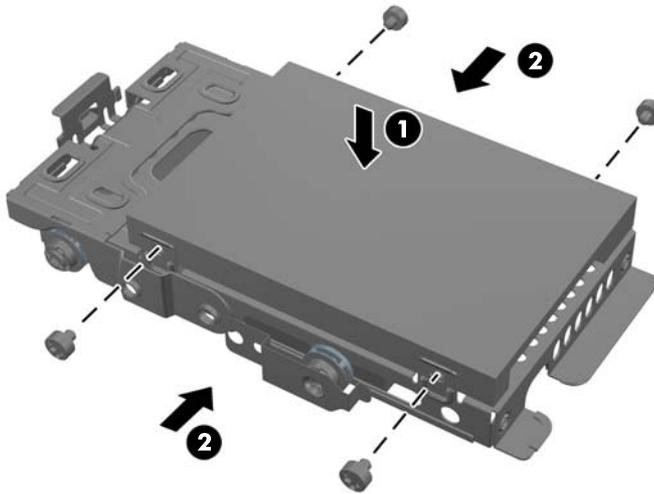
4. Positionieren Sie den 2,5-Zoll-Laufwerksrahmen so oberhalb der endgültigen Einbauposition, dass die Anschlüsse zur Mitte des Gehäuses zeigen. Falls der Laufwerksrahmen ein zweites (oberes) Laufwerk enthält, suchen Sie die Strom- und Datenkabel, die sich neben dem Laufwerksrahmen befinden, und verbinden Sie diese mit dem zweiten Laufwerk.
