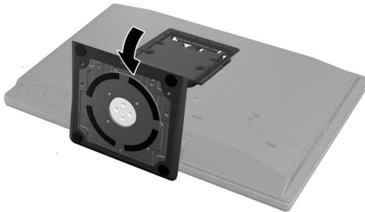
4. Ziehen Sie die beiden Halteschrauben fest, um den Stand am Gehäuse zu befestigen.
