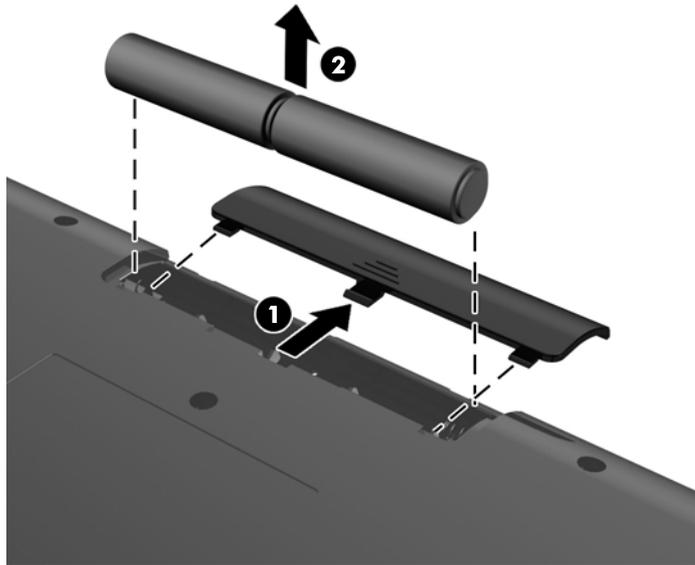
Um die Batterien aus der Funkmaus zu entfernen, nehmen die Batteriefachklappe auf der Mausunterseite ab (1) und heben Sie die Batterien aus dem Batteriefach (2) heraus.
