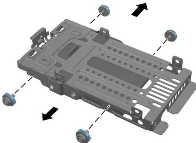
10. Entfernen Sie die 2,5-Zoll-Festplattenlaufwerke aus dem Montagerahmen.
