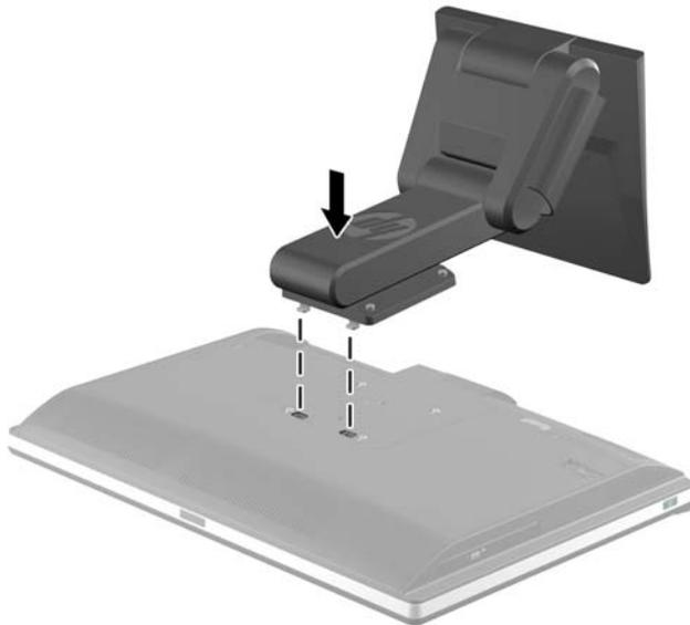
3. Ziehen Sie die vier Halteschrauben fest, um den Ständer am Gehäuse zu befestigen.
