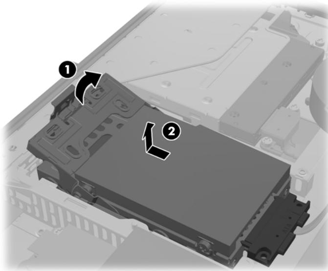
8. Falls sich eine zweite Festplatte im 2,5-Zoll-Montagerahmen befindet, lösen Sie beide Kabel.
