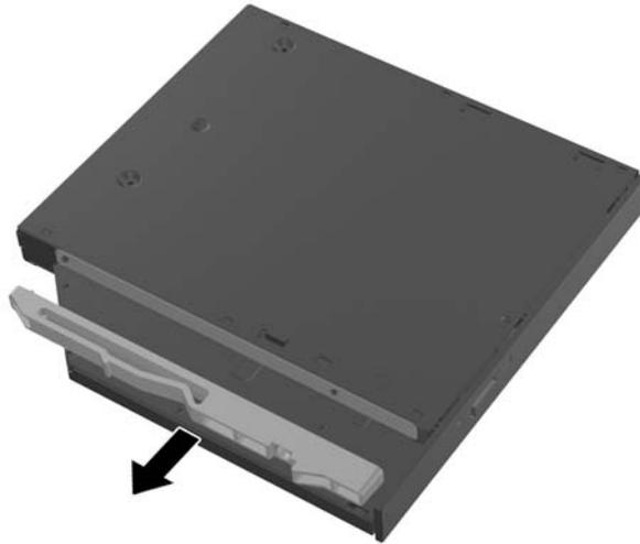
9. Entfernen Sie die Abdeckung des Klebestreifens an der neuen Sicherung. Richten Sie die beiden Stifte an der Sicherung mit den Löchern des neuen optischen Laufwerks aus und drücken Sie die Sicherung fest auf das Laufwerk.
