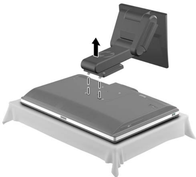
Figur 2-15 Afmontering af stativet
