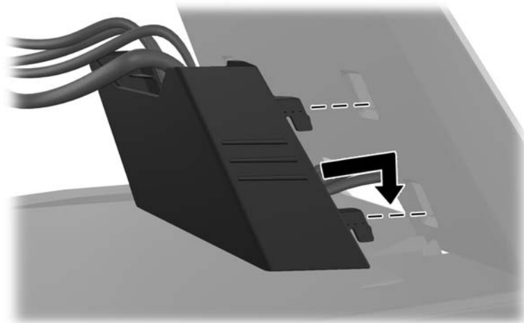
Figur 2-4 Montering af kabelholderdækslet
