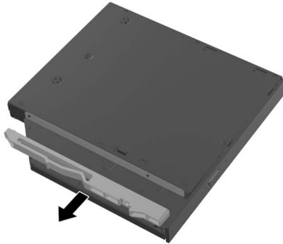
Figur 2-42 Afmontering af det optiske diskdrevbeslag
