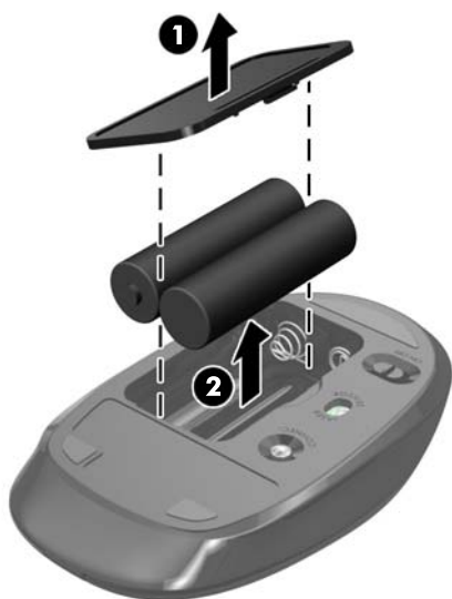
Figur 2-9 Udtagning af batterier fra den trådløse mus
