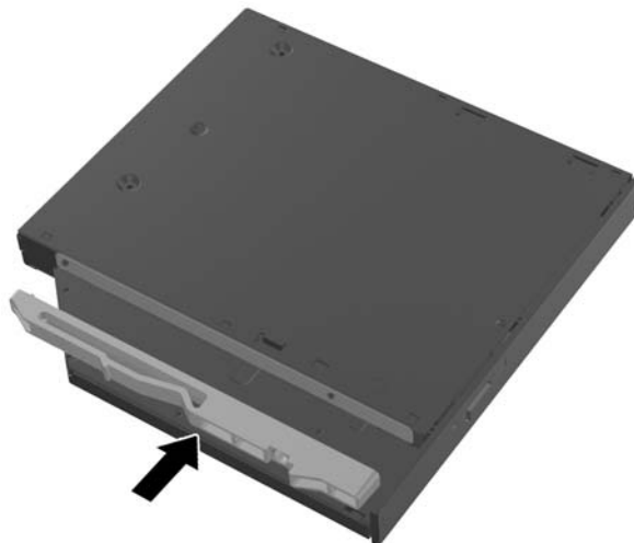
Figur 2-43 Montering af det optiske diskdrevbeslag
