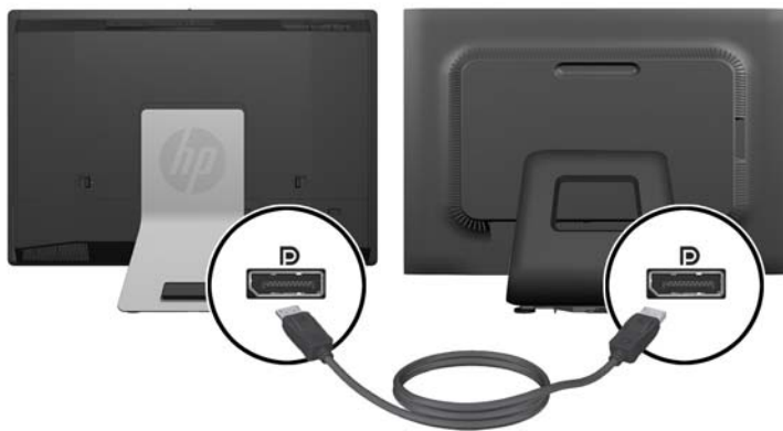
Figur 2-23 Forbindelse af en sekundær skærm
