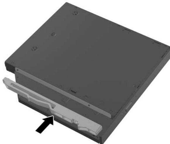
10. Alinhe a nova unidade de disco óptico com a abertura lateral no computador. Empurre a unidade firmemente até encaixar.
