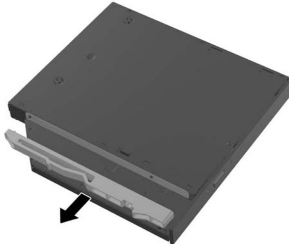
9. Remova a tampa da fita adesiva do novo fecho. Alinhe os dois pinos do fecho com os orifícios da nova unidade de disco óptico e pressione o fecho firmemente contra a unidade.
