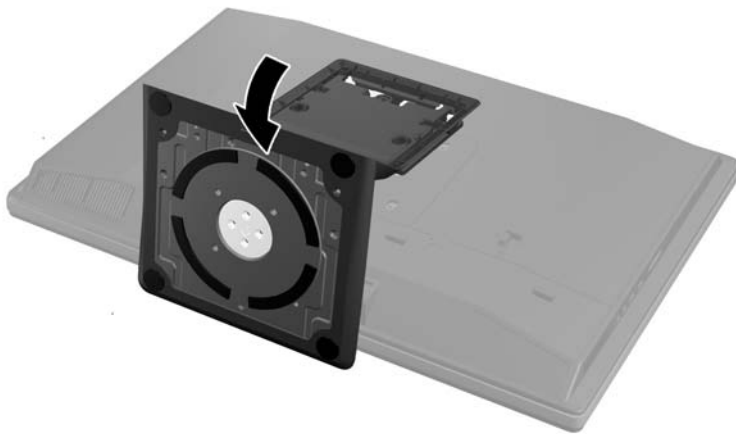
Figura 2-16 Instalación de la base
