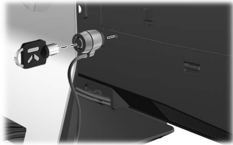
Figura 2-5 Instalación de un bloqueo de cable
