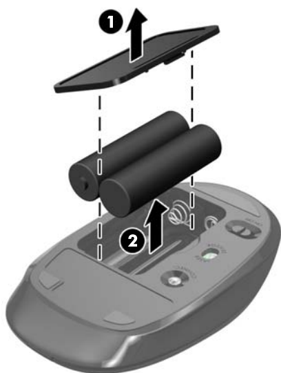
Figura 2-9 Extracción de baterías del mouse inalámbrico
