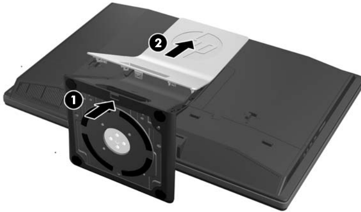
Figura 2-19 Extracción de la parte posterior de la base
