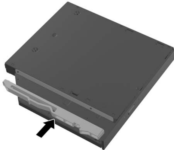
Figura 2-43 Conexión del pestillo de la unidad de disco óptico
