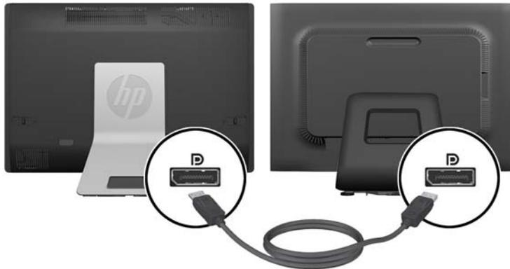
4. Falls Ihr zweites Display keinen DisplayPort-Anschluss hat, verbinden Sie den DisplayPort Video-Adapter mit dem DisplayPort-Anschluss des Computers. Dann schließen Sie ein Kabel (VGA, DVI oder HDMI, je nach Ihrer Anwendung) zwischen dem Adapter und einem zweiten Display.
