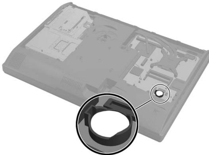
7. Um die Batterie aus der Halterung zu lösen, drücken Sie auf die an einer Seite über die Batterie hinausstehende Metallklammer. Die Batterie springt aus der Halterung, und Sie können sie herausnehmen (1).
