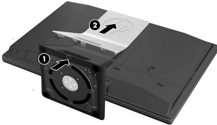
7. Schieben Sie die Basis des Ständers nach unten (1) und lösen Sie die Halteschrauben, die den Ständer am Gerät fixieren (2).
