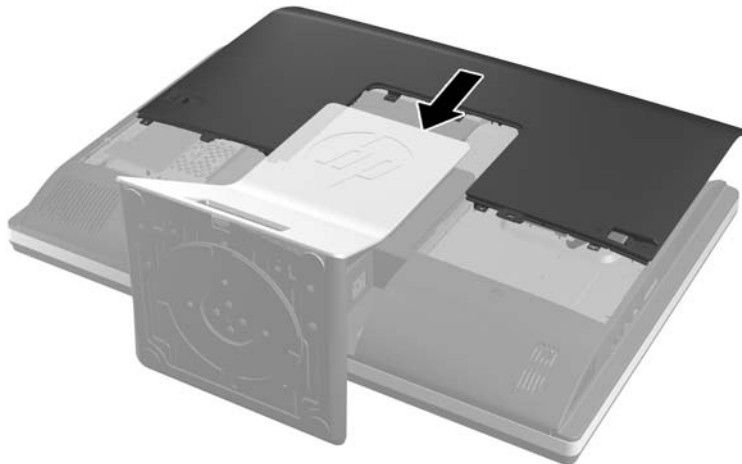
Εικόνα 2-45 Επανατοποθέτηση καλύμματος πρόσβασης
