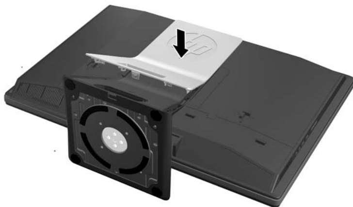
Εικόνα 2-18 Εγκατάσταση του πίσω μέρους της βάσης
