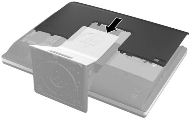
Εικόνα 2-33 Επανατοποθέτηση καλύμματος πρόσβασης
