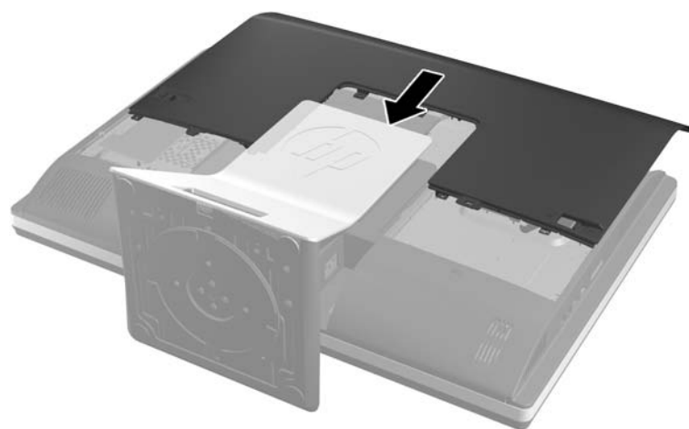
Εικόνα 2-56 Επανατοποθέτηση καλύμματος πρόσβασης
