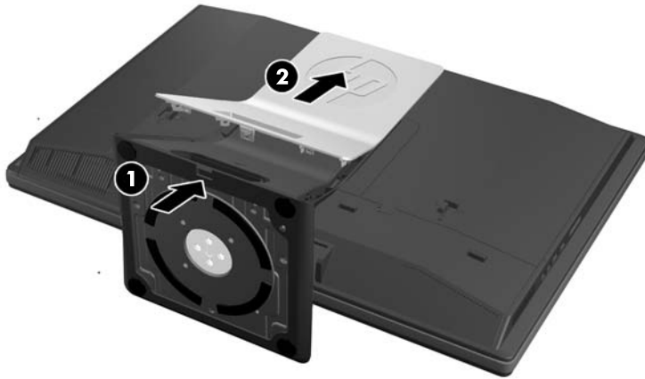
Εικόνα 2-19 Αφαίρεση του πίσω μέρους της βάσης
