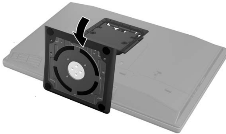
Εικόνα 2-16 Εγκατάσταση της βάσης
