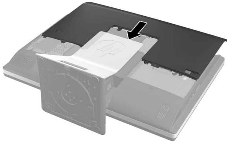
Εικόνα 2-29 Επανατοποθέτηση καλύμματος πρόσβασης
