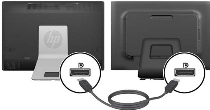
4. Se a segunda tela não possuir um conector DisplayPort, conecte um adaptador de vídeo DisplayPort no conector DisplayPort do computador. Depois conecte um cabo (VGA, DVI ou HDMI, dependendo da aplicação) entre o adaptador e a segunda tela.
