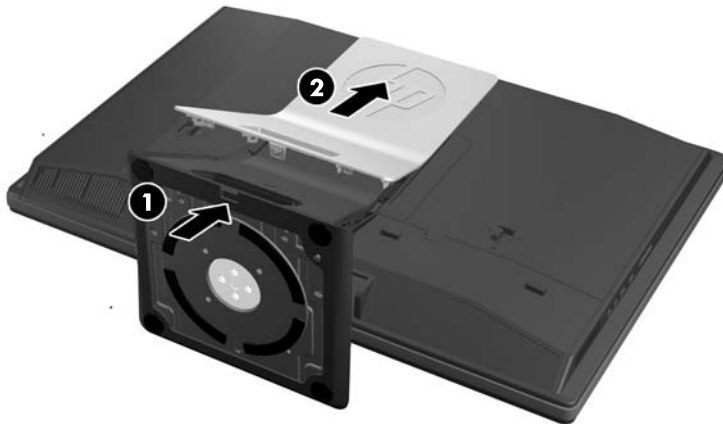
Obrázek 2-19 Sejmутí zadní části podstavce
