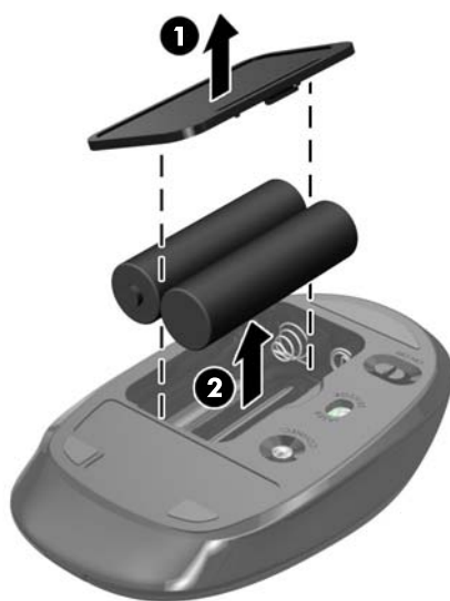
Obrázek 2-9 Vyjmutí baterií z bezdrátové myši
