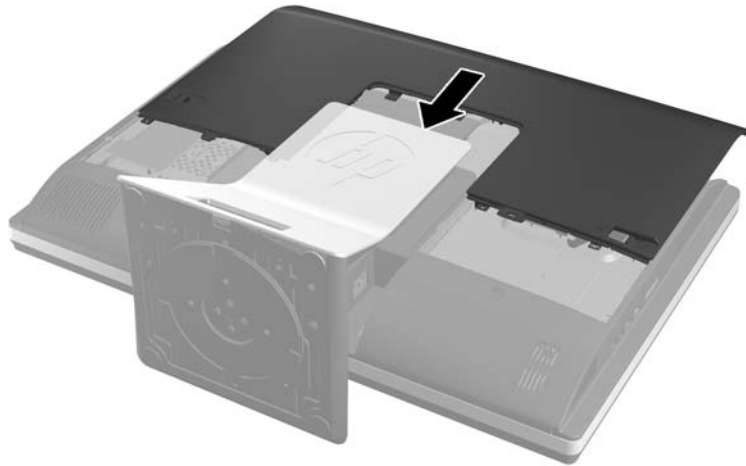
Figura 2-50 Înlocuirea panoului de acces
