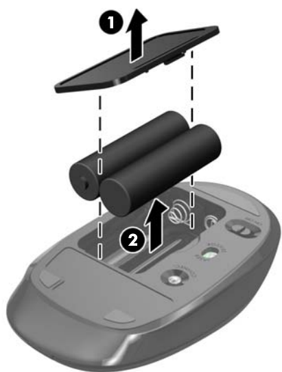
Figura 2-9 Scoaterea bateriilor din mouse-ul wireless
