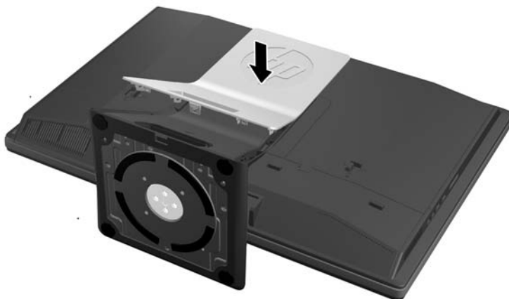
Figura 2-18 Instalarea părții din spate a suportului
