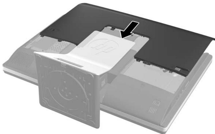
Figura 2-56 Înlocuirea panoului de acces
