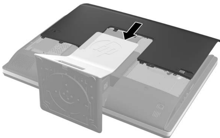
Figura 2-45 Înlocuirea panoului de acces
