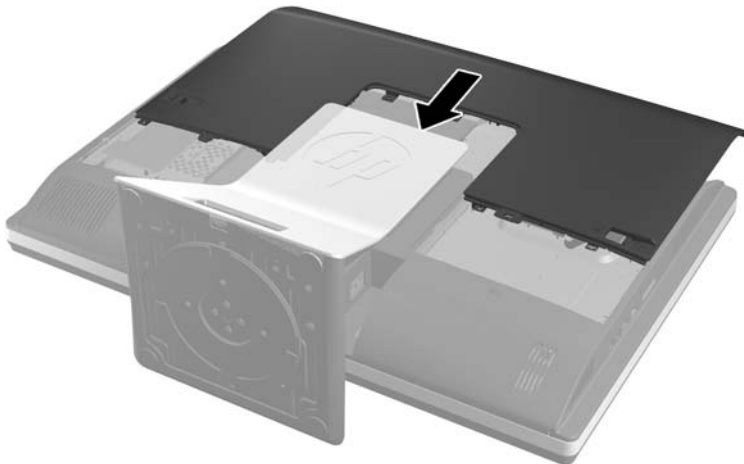
Figura 2-33 Înlocuirea panoului de acces
