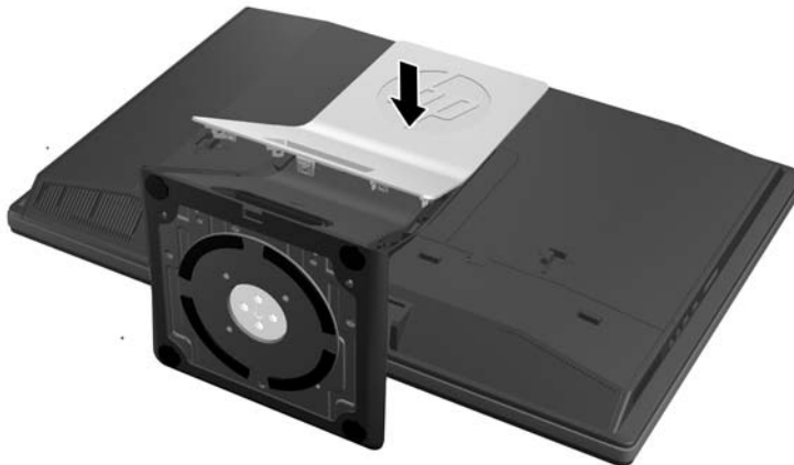
ภาพ 2-18 การติดตั้งด้านหลังของแทนวาง
