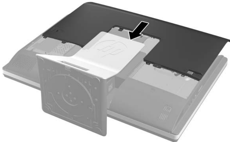
Kuva 2-56 Käyttöpaneelin asentaminen takaisin paikalleen
