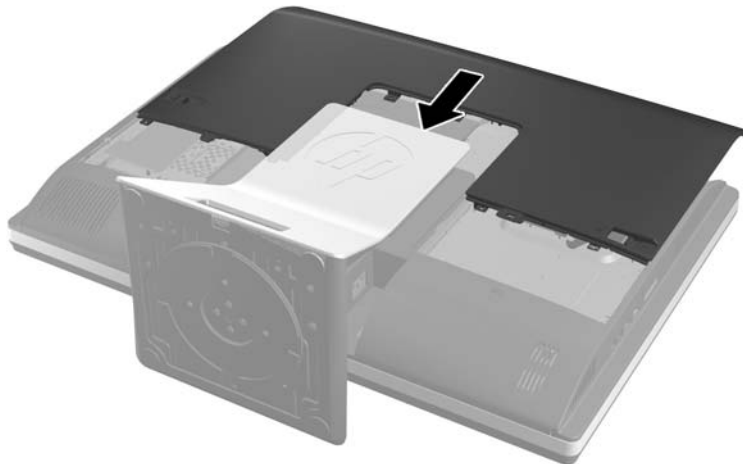
Kuva 2-29 Käyttöpaneelin asentaminen takaisin paikalleen
