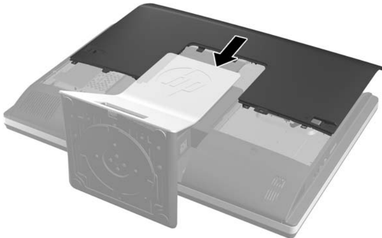
Kuva 2-33 Käyttöpaneelin asentaminen takaisin paikalleen
