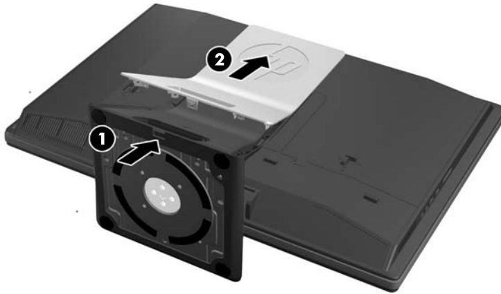
Kuva 2-19 Telineen takaosan poistaminen
