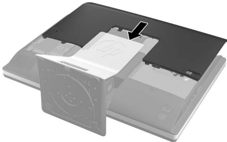
Kuva 2-45 Käyttöpaneelin asentaminen takaisin paikalleen
