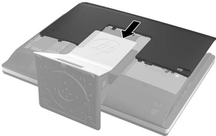
图 2-50 重新装上检修面板
