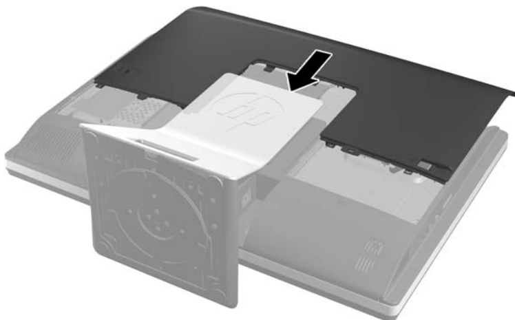
图 2-33 重新装上检修面板
