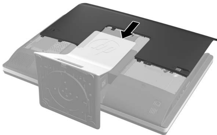
图 2-56 重新装上检修面板
