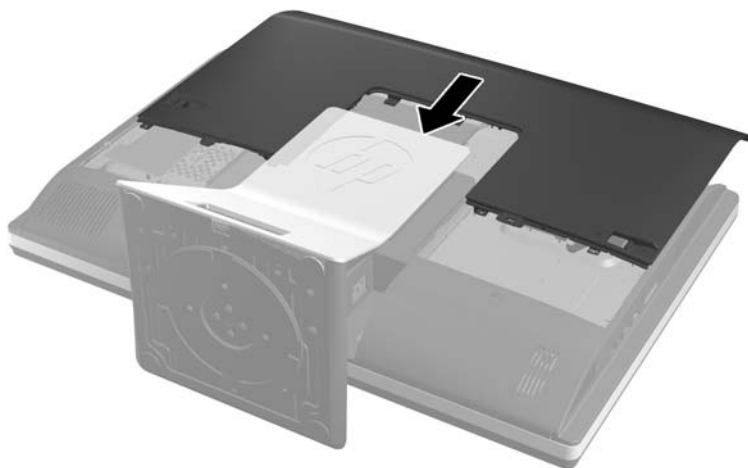
图 2-29 重新装上检修面板
