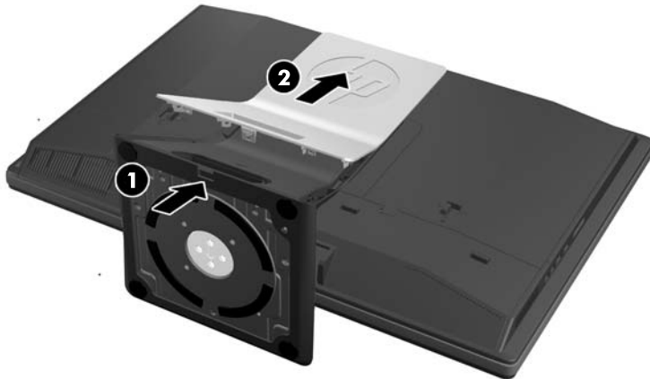
Attēls 2-19 Statnes aizmugures noņemšana
