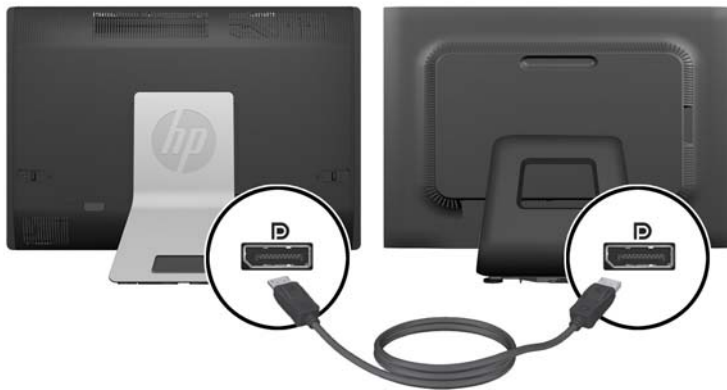
Slika 2-23 Povezivanje drugog ekrana
