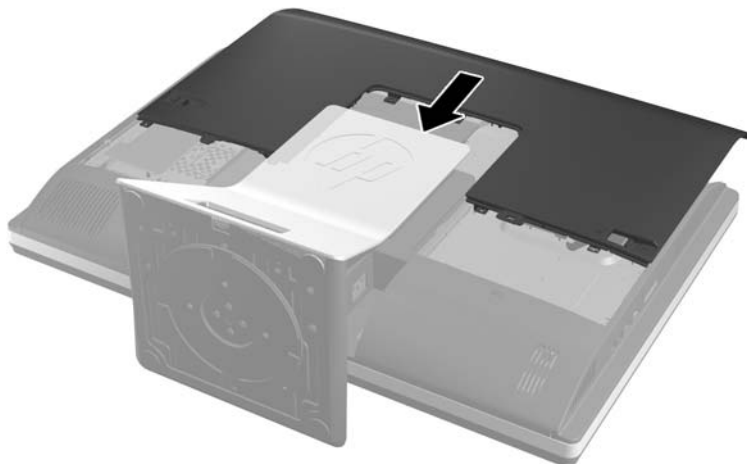
Joonis 2-56 Pääsupaneeli paigaldamine
