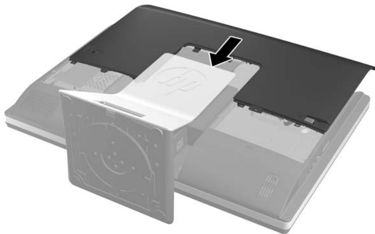
Joonis 2-33 Pääsupaneeli paigaldamine
