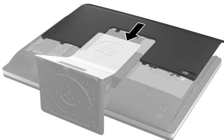
Joonis 2-45 Pääsupaneeli paigaldamine
