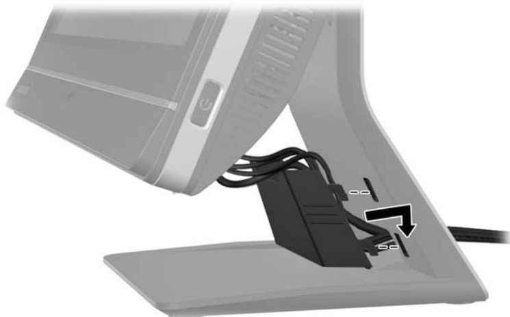
Joonis 2-2 Kaablihalduskatte paigaldamine
