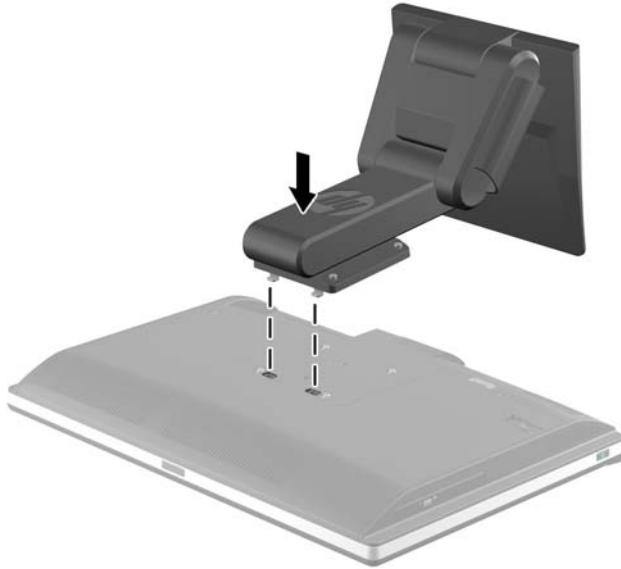
Figura 2-11 Instalación de la base
