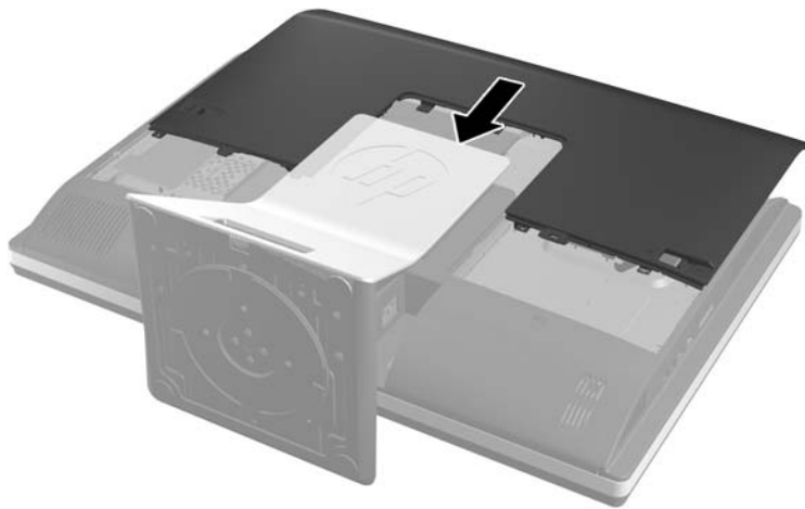
Figura 2-45 Reemplazo del panel de acceso
