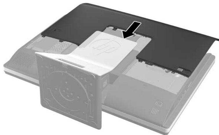
Figura 2-56 Reemplazo del panel de acceso
