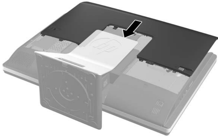
Figura 2-50 Reemplazo del panel de acceso
