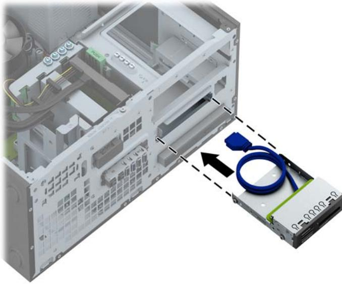
9. Se si installa un lettore di schede di memoria USB 3.0, collegare il connettore del lettore al connettore USB 3.0 sulla scheda di sistema, denominato MEDIA3.0.
