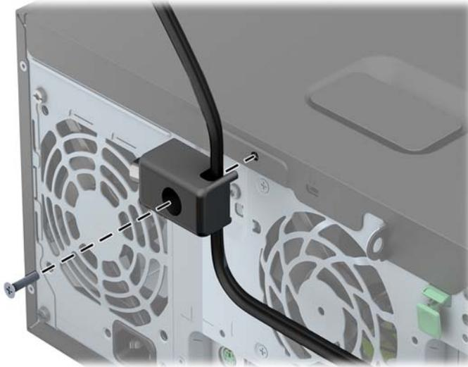
7. Inserire lo spinotto del cavo di sicurezza nel fermo (1) e premere il pulsante (2) per attivare il blocco. Per disattivarlo, utilizzare la chiave fornita.
