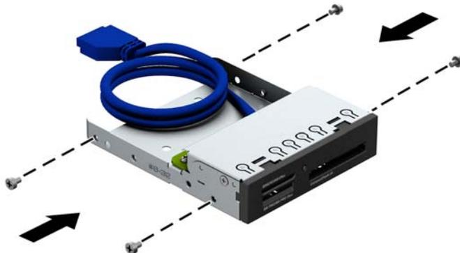
8. Infilare l'unità nell'alloggiamento, allineando le viti ai fori, fino a che non si blocca.
