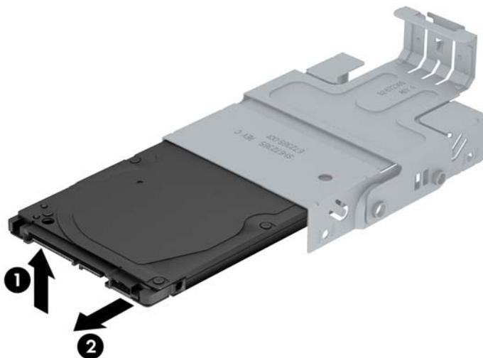
12. Posizionare l'unità disco rigido in modo tale che la parte superiore coincida con la parte superiore del supporto (1) e la scheda dei circuiti nella parte inferiore dell'unità non tocchi le linguette nella parte inferiore del supporto, quindi inserire la nuova unità facendola scorrere nel supporto (2).
