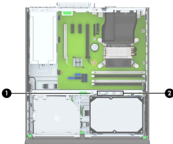
Cinque viti standard 6-32 di colore argento supplementari. Una vite viene utilizzata per il fissaggio del frontalino (1) (vedere [Sicurezza del frontalino a pagina 107](#) per ulteriori informazioni). Le altre quattro viti sono utilizzate come viti guida per lettori di schede di memoria o unità disco rigido secondarie nell'alloggiamento da 3,5" per unità disco rigido opzionale (2).
