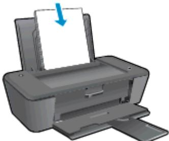
5. Faites glisser le guide de réglage en largeur vers la droite jusqu'à ce qu'il entre en contact avec le bord du papier.
