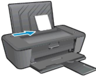
5. Faites glisser le guide de réglage en largeur vers la droite jusqu'à ce qu'il entre en contact avec le bord du papier.
