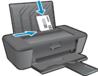
5. Faites glisser le guide de largeur vers la droite jusqu'à ce qu'il entre en contact avec la pile d'enveloppes.
