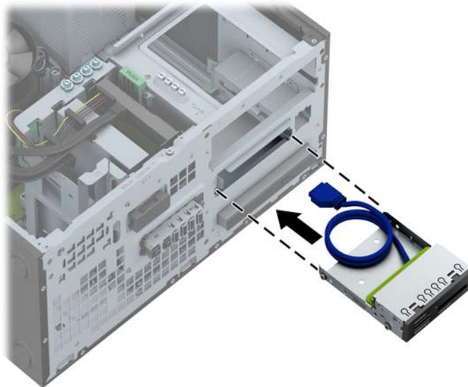
9. Si desea instalar un lector de tarjetas multimedia USB 3.0, conecte el cable USB del lector de tarjetas multimedia al conector USB 3.0 de la placa del sistema rotulado MEDIA3.0.
