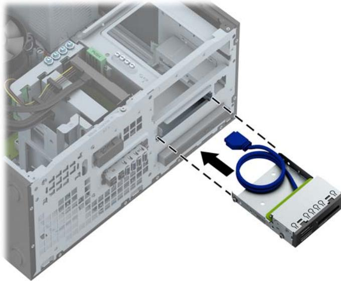
9. Se estiver instalando um leitor de cartão de mídia USB 3.0, você deve usar o adaptador de USB 3.0 para USB 2.0 e conectar o cabo do adaptador do leitor de cartão de mídia no conector USB 2.0 da placa do sistema rotulado como MEDIA.
