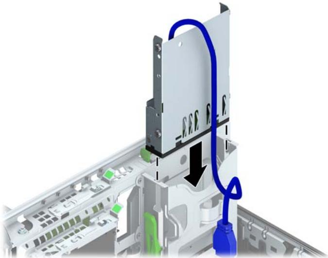
11. Se estiver instalando um leitor de cartão de mídia USB 3.0, você deve usar o adaptador de USB 3.0 para USB 2.0 e conectar o cabo do adaptador do leitor de cartão de mídia no conector USB 2.0 da placa do sistema rotulado como MEDIA.
