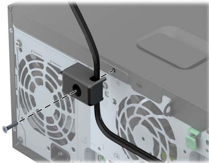
7. Insira o plugue do cabo de segurança no bloqueio (1) e pressione o botão (2) para prender o bloqueio. Use a chave fornecida para desprender o bloqueio.
