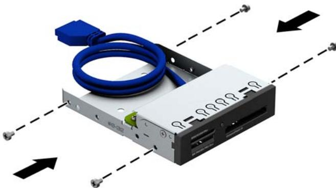
8. Deslize a unidade para dentro do compartimento, assegurando-se de alinhar os parafusos-guia com os slots, até a unidade encaixar-se em seu lugar.
