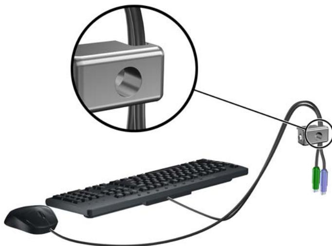
6. Завинтете ключалката към шасито в отвора с осигуриения винт.
