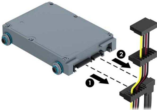
7. Освободете устройството, като издърпate накрайника за освобождаване навън от устройството (1) и пълзнете устройството навън от гнездото (2).
