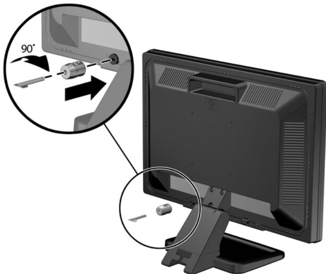
3. Плъзнете защитния кабел през отвора в кабелния фиксатор от задната страна на монитора.
