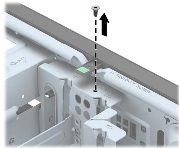
7. Монтирайте защитния винт през средния освобождаващ език на лицевия панел, за да закрепите лицевия панел на мястото му.
