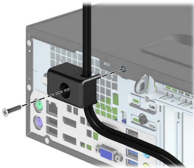
7. Вкарайте накрайника за вмъкване на защитния кабел във фиксатора (1) и натиснете бутона навътре (2), за да заключите фиксатора. За отключване на фиксатора ползвайте предоставения ключ.
