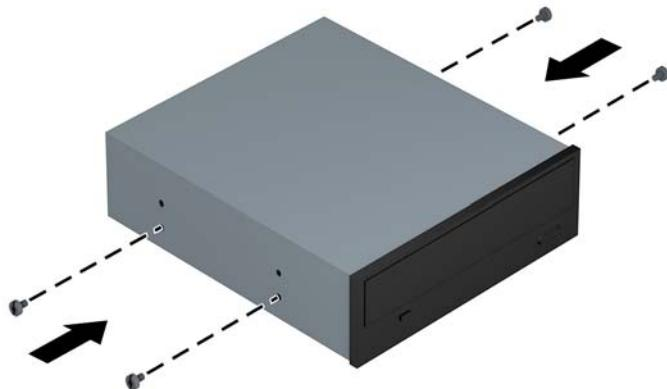
8. Пълзнете устройството в гнездото, като внимавате водещите винтове да се подравнят с водещите слотове, докато то щракне на място.
