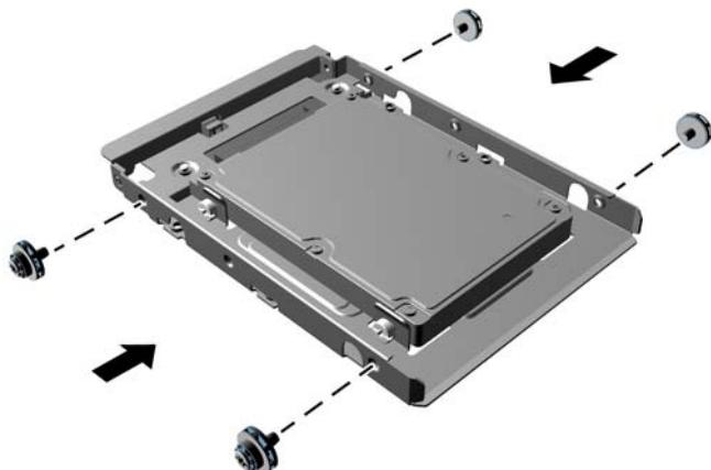
7. Пълзнете устройството в отделението му, като осигурите правилно подравняване на водещите винтове с водещите канали, докато устройството щракне на място.
