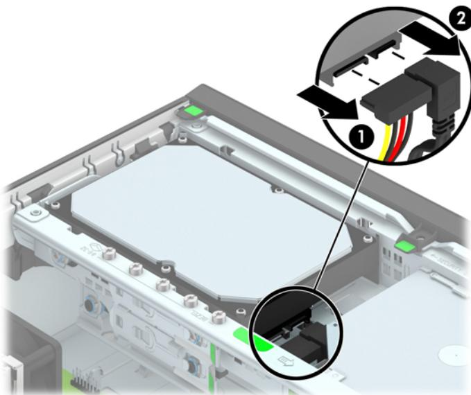
8. Издърпайте лостчето за освобождаване до задната част на твърдия диск навън (1). Докато издърпвате лостчето за освобождаване, пълзнете устройството назад, докато спре, а след това вдигнете устройството нагоре и навън от отделението (2).
