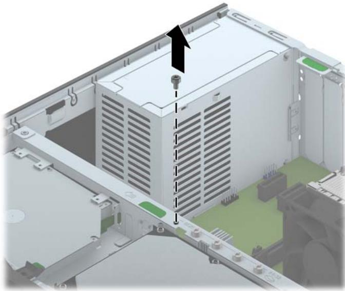
8. Монтирайте защитния винт през средния освобождаващ език на лицевия панел, за да закрепите лицевия панел на мястото му.
