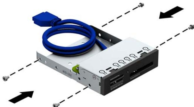
8. Пълзнете устройството в гнездото, като внимавате водещите винтове да се подравнят с водещите слотове, докато то щракне на място.
