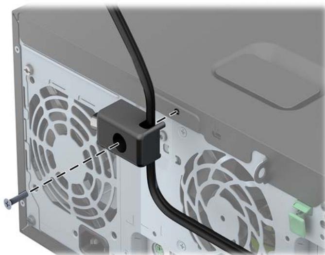
7. 將安全纜線尾端的插銷插入鎖中 (1)，並按下按鈕以嚙合鎖 (2)。使用鉗夾鎖提供的鑰匙，來解開鉗夾鎖。
