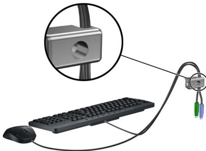
6. 使用提供的螺絲，將鎖固定於機殼的指旋螺絲孔上。
